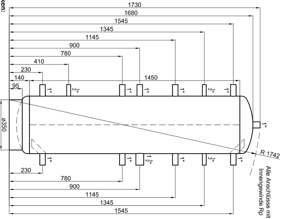
Alle Anschlüsse mit Innengewinde Rp
