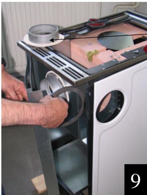
Sie können nun den hinten entfernten Rauchrohrstutzen, die Dichtung und den Befestigungsring analog an der Seite wieder befestigen.
