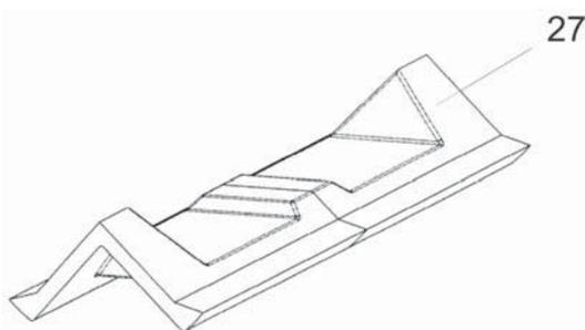
Das Dach besteht aus zwei gleichen Stücken mit einer Länge von 500 mm - s. Abb.
