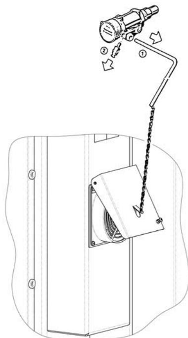
Demontieren Sie den Hebel (1) und das Verbindungsstück (2)
