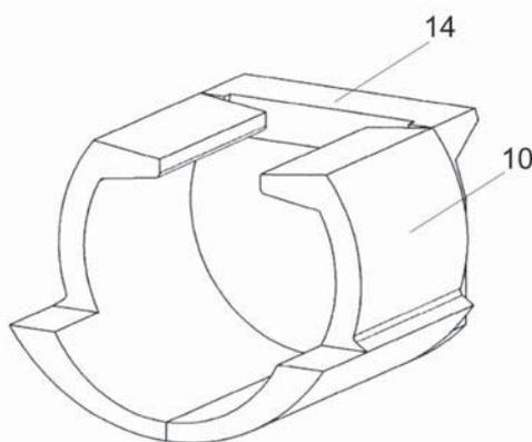
Der Formstein (kugelförmiger Raum) muss so zusammengesetzt werden, dass der Vorderteil des Formsteins 3 cm von dem vorderen Kesselteil entfernt ist.
