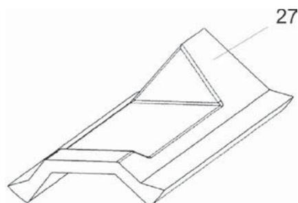
Der Formstein (Dach) des Kesselfeuerungsraums muss bis zur hinteren Wand des Kessels vorgeschoben werden
