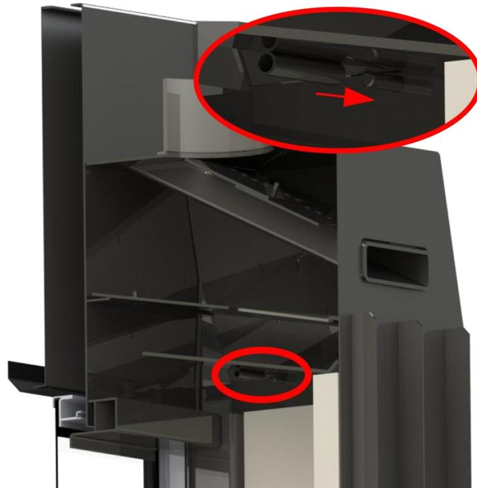
Legen Sie die untere Prallplatte in den Feuerraum ein. Legen Sie die Prallplatte mit hinterem Teil auf die Feuerbetonplatte (siehe Abb. 3). Heben Sie den vorderen Teil der Prallplatte an und stecken Sie die Röhrchen (im Lieferumfang) auf die Seitenstifte im Feuerraum. Die Stifte befinden sich über den seitlichen Feuerbetonplatten auf der rechten und linken Seite. Dann legen Sie die Prallplatte auf die Röhrchen. Damit ist die Montage der Prallplatten fertig.
