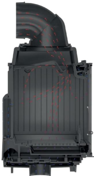
Die Luft zum Verbrennen wird **ausschließlich von außen** geliefert. Der Kamineinsatz hat **in der Standardausführung die Zuluft von außen** – es wird ein Zuluftstutzen fi 125 mm eingebaut. Die Luftverteilung in die Brennkammer erfolgt im Raum (Luftkammer) unterhalb der unteren Platte des Kamineinsatzes.
