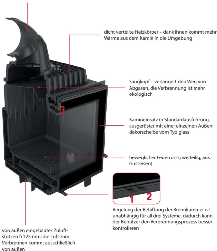
dreifaches System der Belüftung der Brennkammer;
