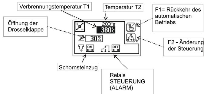
Rückkehr des automatischen Betriebs mit der Taste „F1“(3).
