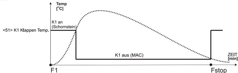
Parameter "<50> K1 Trieb"=2. Im Ruhezustand ist der Ausgang K1 eingeschaltet. Die Klappe ist nach dem Schornstein gelenkt. Nach der Erreichung der voreingestellten Temperatur ("<51> K1 Klappen Temp") schaltet sich die Klappe aus und schickt die Klappe die Verbrennungsgase zu MAC. Nach der Verbrennungsphase, wird K1 eingeschaltet. Die Klappe ist wieder nach dem Schornstein gelenkt.
