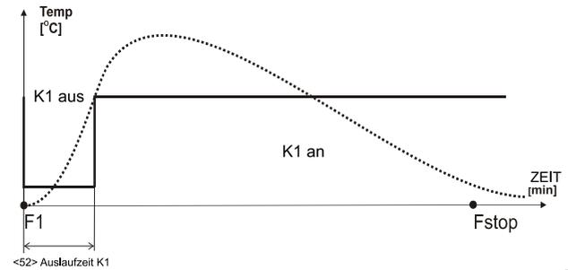
Parameter "<50> K1 Trieb"=5. An den Ausgang K1 wird die Ventilation angeschlossen. Diese schaltet sich nach dem Öffnen der Tür des Kamins (es ist ein Türkontaktschalter nötig) aus und schaltet sich nach 1min (Parameter "<52> Auslaufzeit K1") vom Schließen dieser ein.
