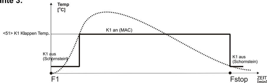
Parameter "<50> K1 Trieb"=3. Im Ruhezustand ist der Ausgang K1 ausgeschaltet. Die Klappe ist nach dem Schornstein gelenkt. Nach der Erreichung der voreingestellten Temperatur ("<51> K1 Klappen Temp") schaltet sich die Klappe ein und schickt die Klappe die Verbrennungsgase zu MAC. Nach der Verbrennungsphase, wird K1 ausgeschaltet. Die Klappe ist wieder nach dem Schornstein gelenkt.
