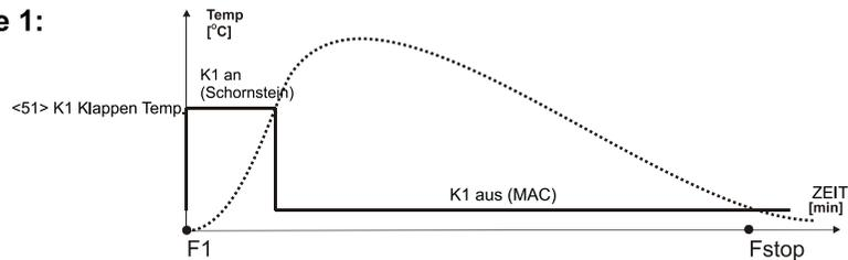
Parameter "<50> K1 Trieb"=1. Im Ruhezustand ist der Ausgang K1 ausgeschaltet. Die Klappe ist nach MAC gelenkt. Der Beginn der Verbrennung verursacht die Einschaltung des Ausgangs K1 und das Ablenken der Verbrennungsgase direkt nach dem Schornstein. Nach der Erreichung der voreingestellten Temperatur ("<51> K1 Klappen Temp") schaltet sich die Klappe aus und schickt die Klappe die Verbrennungsgase zu MAC.
