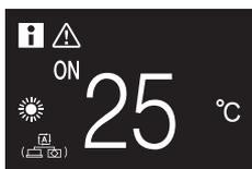
**Ergebnis:** Bei der Inneneinheit wird der Temperatur-Sollwert geändert.
