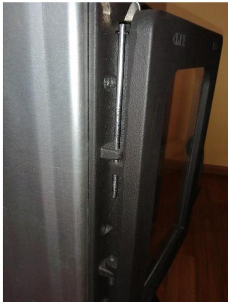
5. Entfernen Sie die untere Niete. Setzen Sie die Feder auf den Stift und schieben Sie sie von unten. Das längere Ende der Feder sollte oben sein.
