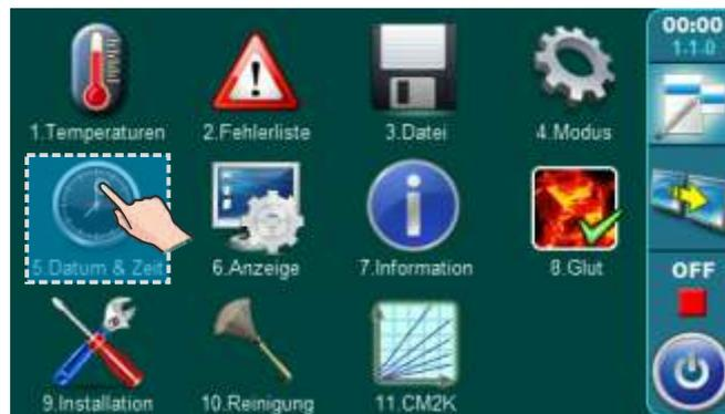
Mit dieser Funktion wird das Datum und die Uhrzeit eingestellt. Dies ist wichtig für die Zeitprogramme und für die Fehlermeldungen. Drücken Sie nach dem Einstellen von Datum und Uhrzeit die Taste "BESTÄTIGEN", um die Einstellung zu speichern. Die Uhr kann falsch sein, die Verschiebung kann 2-3 Minuten pro Monat betragen, was als normal angesehen wird, wir empfehlen Ihnen, sie regelmäßig anzupassen.
