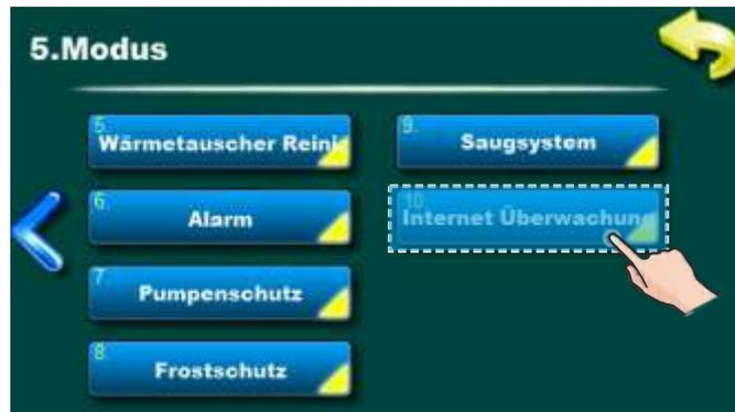
Wenn die Internetüberwachung verbunden und aktiviert ist, wird auf dem Hauptbildschirm ein neues Symbol angezeigt, das den Status der Internetüberwachung (Internet Kessel-Verbindung und Webportal) anzeigt.
