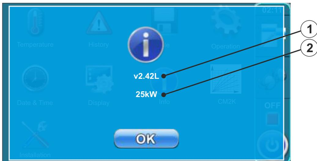
Bei dieser Funktion wird die Softwareversion (1) und die Kesselennennleistung (2) angezeigt.
