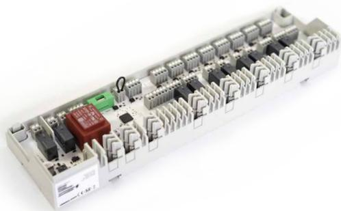
Die neue MAINFLOOR Klemmleiste Balance ist die zentrale Anschlusseinheit sowie Spannungsversorgung für alle Komponenten des OEM Alpha direct Systems. In übersichtlicher Anordnung werden Stellantriebe und Regler einfach und komfortabel miteinander verbunden.
