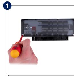
Entfernen Sie den Deckel der Klemmleiste.
