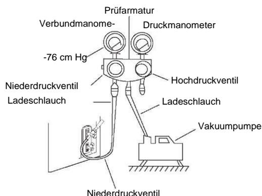
1. Verbinden Sie den Ladeschlauch der Prüfarmatur mit dem Serviceanschluss am Außengerät-Niederdruckventil.
