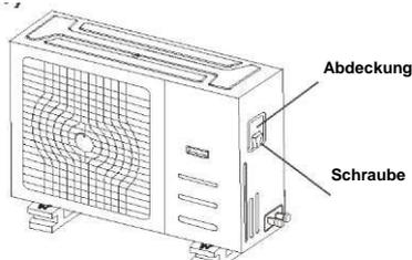
3. Verbinden Sie die U-Kabelschuhe mit den Klemmen. Schließen sie die Drähte nach den Farben/Bezeichnungen an der Klemmleiste an, und ziehen Sie die Kabelschuhe an der entsprechenden Klemme fest.
