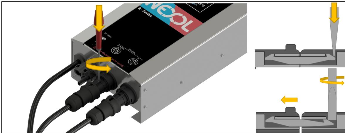
Abbildung 30: Lösen der Steckverbindungen zwischen Einschraubheizkörper und Nexol Energy Controller
