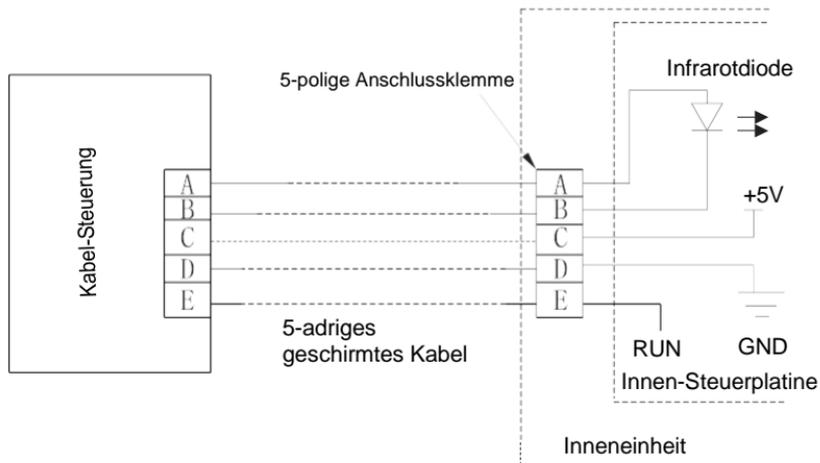
Wenn eine Kabel-Steuerung nötig ist, sollte eine kleine 5-polige Anschlussklemme ergänzt und eine Infrarotdiode mittels Gummiwasser in der Nähe des Empfängers an der Steuerplatine angebracht werden. Verbinden Sie die Anode und Kathode mit A und B sowie +5V, GND, RUN mit C, D, E an der Steuerplatine.
