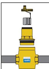
La particolare costruzione del disaeratore-defangatore DISCALDIRT® permette di effettuare operazioni di manutenzione e di pulizia senza dover rimuovere il dispositivo dall'impianto, in particolare:
