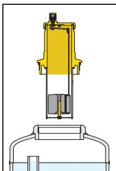
De constructie van de DISCALDIRT® lucht- en vuilafscheider laat onderhouds- en schoonmaakwerkzaamheden toe zonder het toestel uit de installatie te moeten verwijderen. In het bijzonder:
