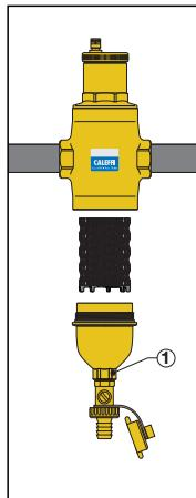
Per l'eventuale manutenzione del disaeratore-defangatore filettato, è sufficiente svitare la camera accumulo fanghi, con una chiave esagono 26 mm (1), alla quale l'elemento interno risulta fissato in modo tale da poter essere sfilato per la pulizia.
