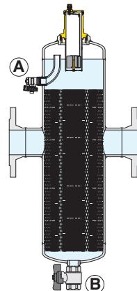
Die Mikroblasen-Schlammabscheider mit Flansch- und Schweißanschluß haben einen Entleerungshahn (A) mit zweifacher Funktion:
