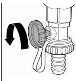
La cámara de acumulación del separador de aire-desfangador con rosca está dotada de una válvula de bola para abrir y cerrar el flujo. Aplicándole el mando que se suministra, es posible descargar las impurezas incluso con el sistema en funcionamiento.
