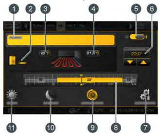
Abb. 8-52: Fussbodenheizung mit Raumfühler
