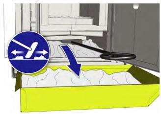
Abb. 9-5: Asche aus dem Ascheabsetzkanal entfernen
