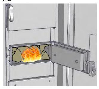
Bei 100°C Abgastemperatur, Anheiztür und Isoliertür schließen
