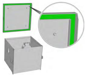
Abb. 9-9: Aschebox entleeren, Dichtung kontrollieren
