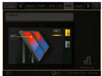
Abb. 8-68: Solaranlage mit Umschaltung zwischen 2 Register am Puffer
