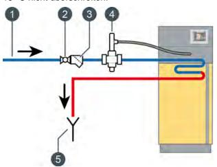
Abb. 4-2: Thermische Ablaufsicherung
