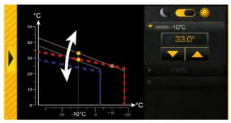
Abb. 8-62: Heizkurve anpassen (bei Aussentemperaturen unter dem Gefrierpunkt)
