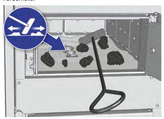
Abb. 7-2: Asche und Kohle gleichmäßig verteilen
