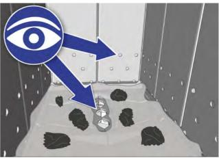
Abb. 9-3: Öffnungen für Primärluft und Durchbrandöffnungen
