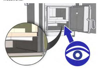
Abb. 9-6: Wände im Ascheabsetzkanal prüfen
