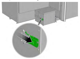
Abb. 9-7: Spannverschlüsse öffnen
