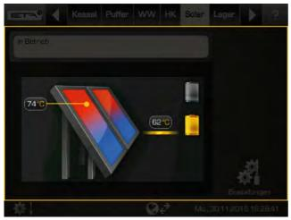
Abb. 8-71: Solaranlage mit externem Wärmetauscher und Schichtladeventil
