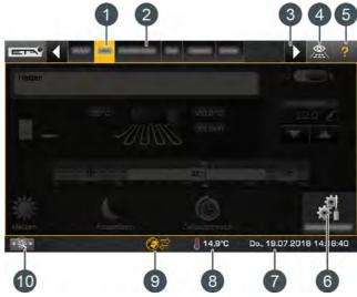
Abb. 8-1: Funktionsblöcke der ETAtouch Regelung
