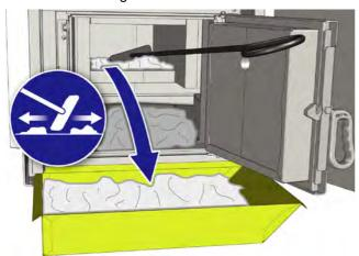
Abb. 9-4: Asche aus der Brennkammer entfernen
