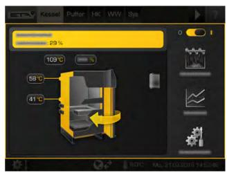
Durch das Schließen der Isoliertür wechselt der Kessel automatisch in den Zustand [Anheizen] und sobald der Restsauerstoffgehalt unter 15% liegt in den Zustand [Heizen]. Der Kessel befindet sich nun im Heizbetrieb und regelt selbstständig die Verbrennung des eingelegten Holzes.
