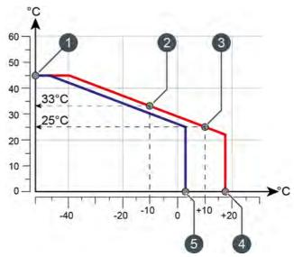
Abb. 8-58: Heizkurve einer Fussbodenheizung
