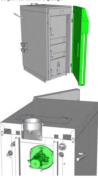
Läuft der Saugzugventilator nicht, liegt entweder ein Fehler oder ein Alarm vor. Überprüfen Sie deshalb die Meldungen am Bildschirm.
