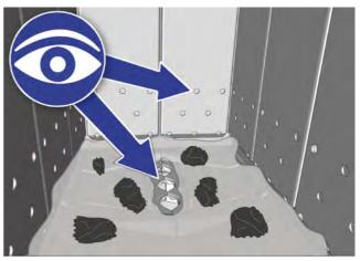
Abb. 7-3: Öffnungen für Primärluft und Durchbrandöffnungen
