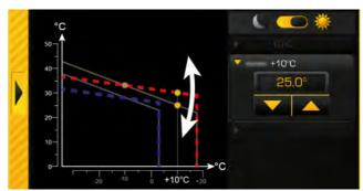
Abb. 8-61: Heizkurve anpassen (bei Aussentemperaturen über dem Gefrierpunkt)
