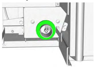
Abb. 9-10: Dichtung kontrollieren
