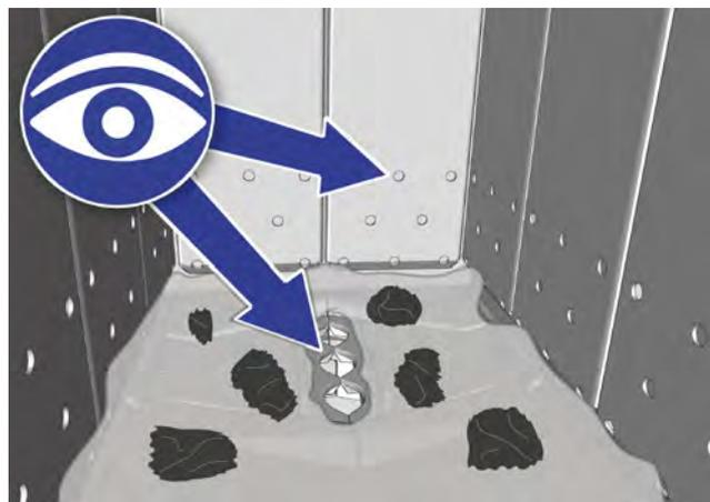
Abb. 7-3: Öffnungen für Primärluft und Durchbrandöffnungen
