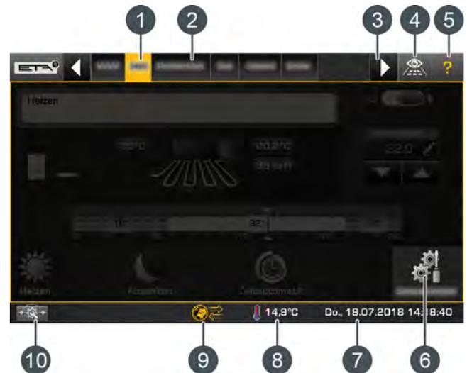
Abb. 8-1: Funktionsblöcke der ETAtouch Regelung
