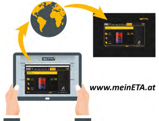
Für die Internetverbindung wird eine LAN-Steckdose in der Nähe des Kessels benötigt. Ist keine vorhanden, kann die Internetverbindung mit "dLAN-Adapter" über das hauseigene Stromnetz hergestellt werden. Diese dLAN-Adapter sind auch bei ETA erhältlich.
