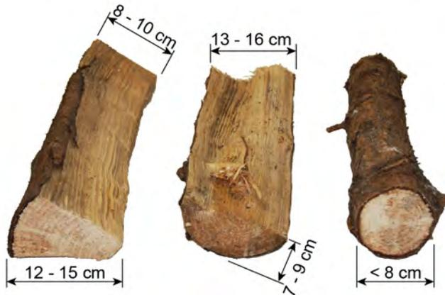
Rundholz kleiner als 8 cm Durchmesser nicht spalten, sondern zwischen den Holzscheiten in der Mitte einlegen.
