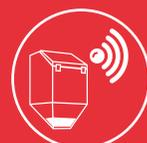
Füllstandsensoren im Pelletbehälter zur Anzeige der Reservemenge und Unterbrechung des Betriebs, damit die Förderschnecke nicht leer läuft
