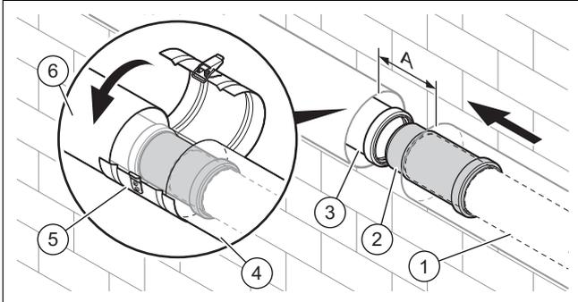
1. Schieben Sie die Trennvorrichtung (2) so weit wie möglich auf das Abgasrohr (1).
