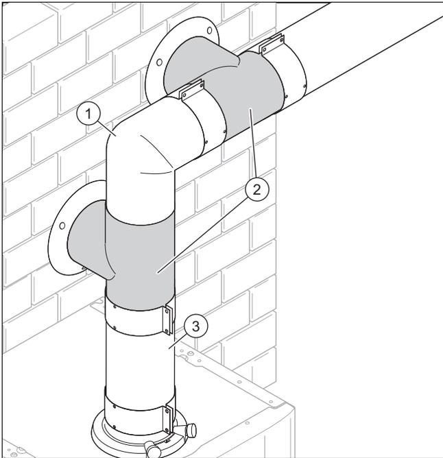
1. Wählen Sie die geeignete Position des Luftanschlus-T-Stücks (2) entweder unmittelbar an dem Produktanschluss (3) oder nach dem ersten Bogen (1).
