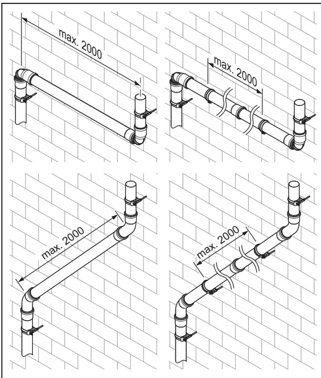
1. Beachten Sie bei der Montage eines Versatzes die maximalen Abstände.
