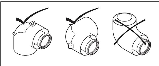
Eine falsche Einbaulage führt zu Kondensat Austritt am Deckel der Revisionsöffnung und kann zu Korrosionsschäden führen.
