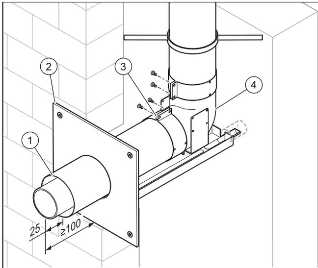
1. Kürzen Sie entsprechend dem Abstand die Verlängerung (1) und verbinden Sie den Stützbogen (4) über die Luftrohrschele (3) mit der Verlängerung.
