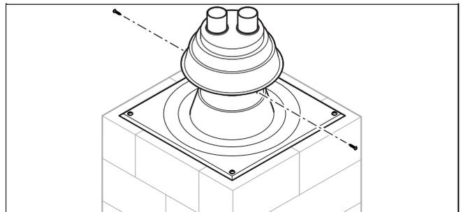
12. Montieren Sie die selbstschneidenden Sicherungsschrauben.
