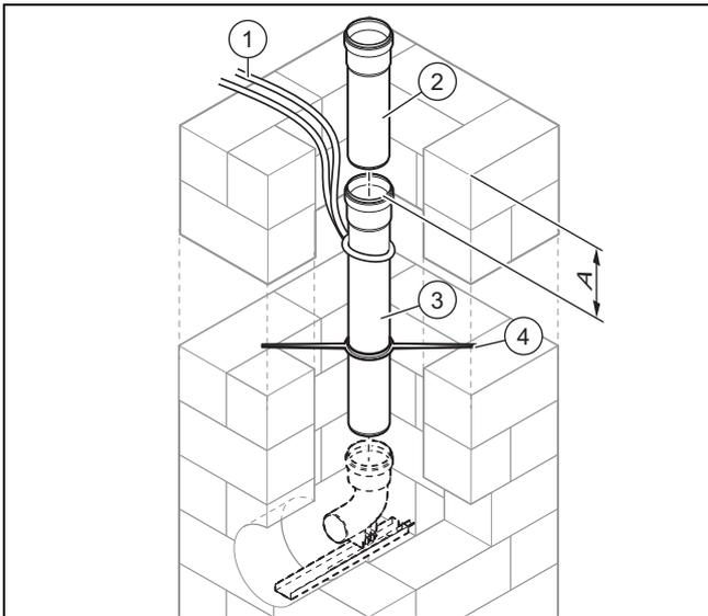
2. Lassen Sie das erste Abgasrohr (3) mit Hilfe eines Seils (1) so weit herunter, bis Sie das nächste Abgasrohr aufstecken können.
