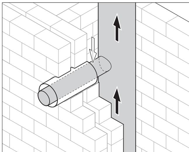
1. Erstellen Sie am Luft-Abgas-System einen Anschluss für raumluftunabhängige Betriebsweise, unter Beachtung der Anschlusshöhe des Produkts (inklusive Anschlussstück für Luft-Abgas-Führung und Bogen), wie in der Installationsanleitung des Produkts beschrieben.
