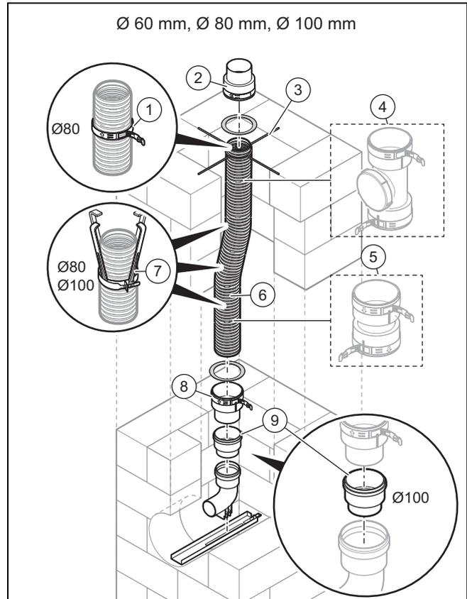
1. Montieren Sie die Auflageschiene und den Stützbogen. (→ Seite 25)
