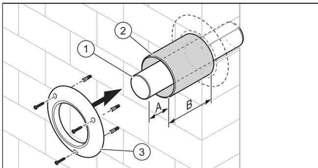
1. Kürzen Sie das Abgasrohr (1) auf die entsprechende Länge und stecken Sie das Abgasrohr auf den Stützbogen.
