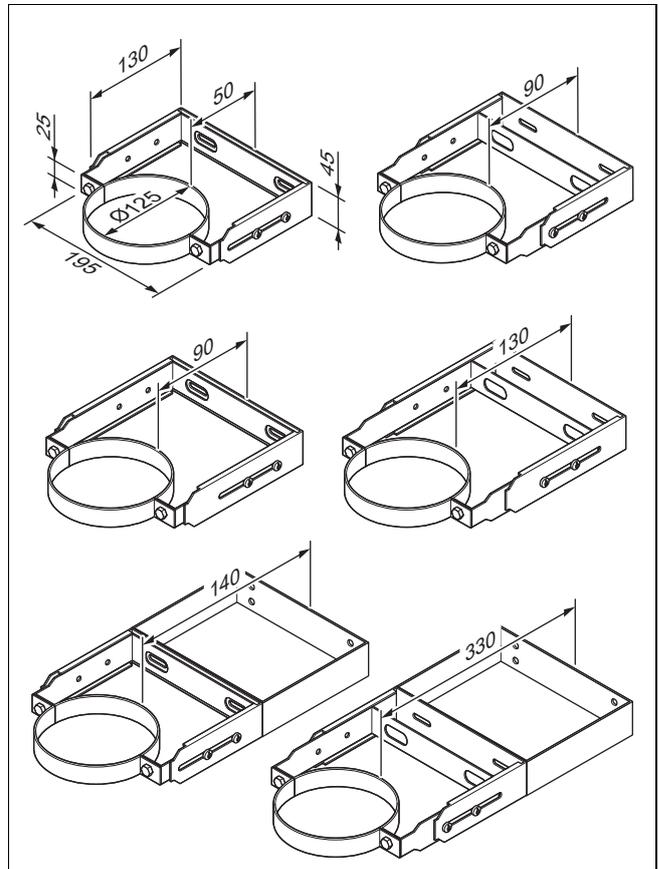
18. Montieren Sie das Unterteil des Rohrleitungshalters Außenwand (3).
