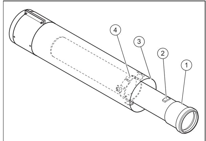
1. Drehen Sie das Abgasrohr (1), bis sich die Kunststoffnase (2) aus dem Abstandshalter (4) löst.
