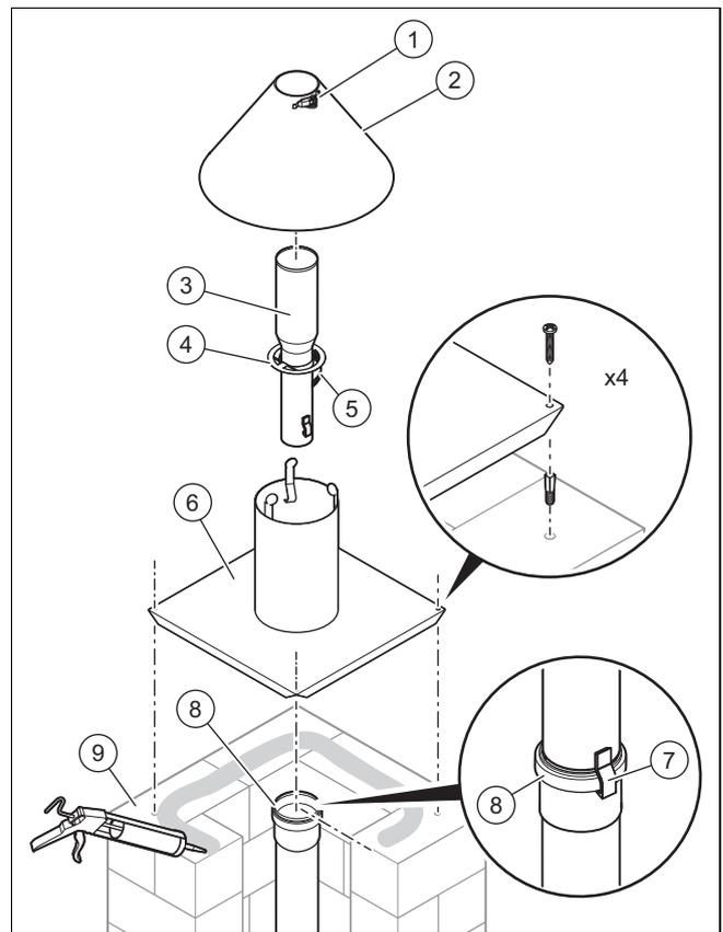
2. Kürzen Sie das letzte Abgasrohr so, dass die Muffe (8) bündig mit der Schachtoberkante endet.
