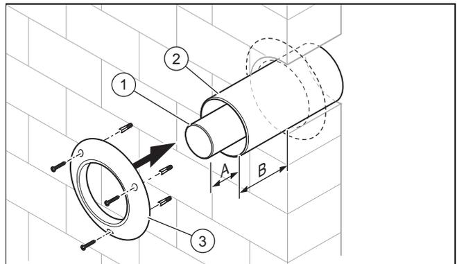
1. Kürzen Sie das Abgasrohr (1) auf die entsprechende Länge und stecken Sie das Abgasrohr auf den Stützbogen.
