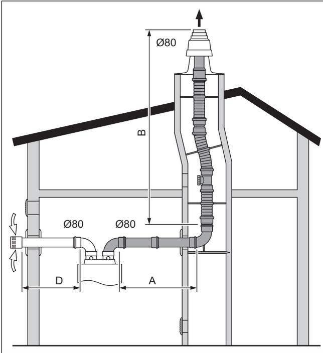
1. Beginnen Sie den Aufbau des Systems mit der Montage der flexiblen Abgasleitung (→ Seite 27) unter Beachtung der entsprechenden Rohrlängentabellen.
