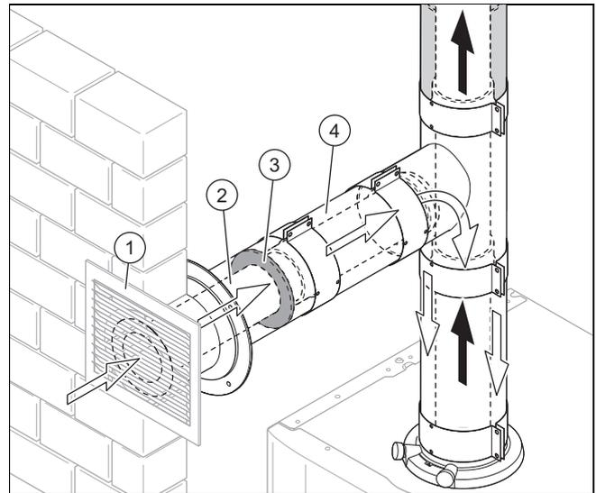
Die Zuluft strömt durch das Zuluftgitter (1) und wird durch das Innenrohr (2) der konzentrischen Rohrleitung geführt. Der Ringspalt (4) ist durch eine Dichtung (3) für die Luftströmung gesperrt. Die stehende Luftschicht im Ringspalt dient als Wärmedämmung und vermeidet bei kalten Außentemperaturen die Schwitzwasserbildung an der Oberfläche des Außenrohrs.
