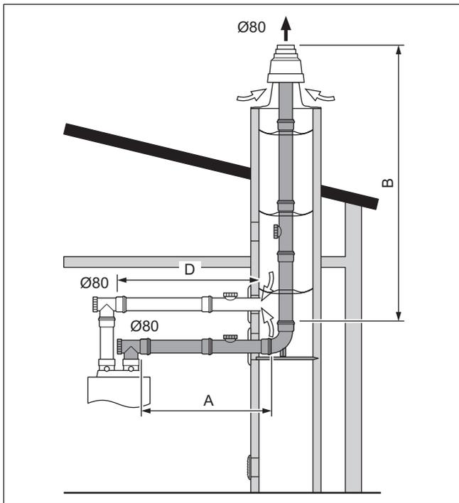
1. Beginnen Sie den Aufbau des Systems mit der Montage der starren Abgasleitung (→ Seite 27) unter Beachtung der entsprechenden Rohrlängentabellen.
