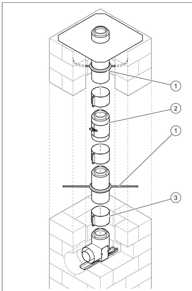
1. Montieren Sie die Auflageschiene und den Stützbogen. (→ Seite 25)
