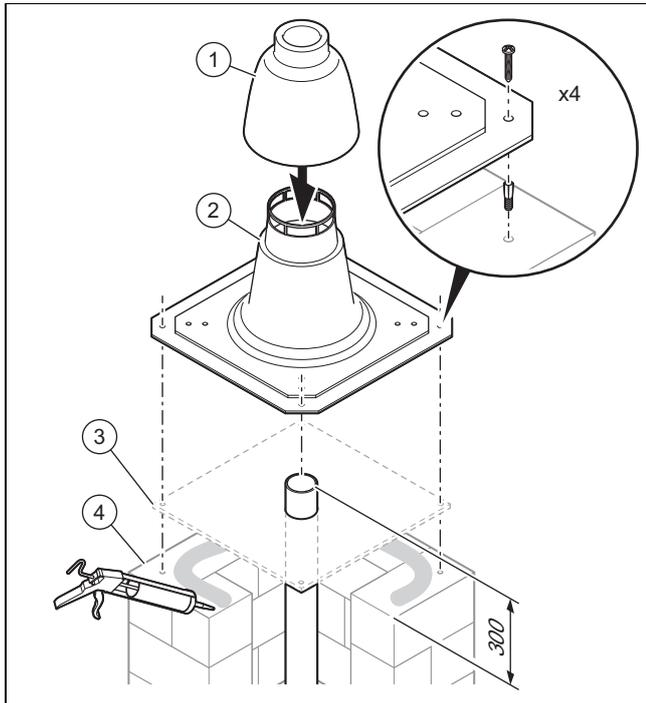
2. Entfernen Sie ggf. die Muffe des obersten Abgasrohrs und kürzen Sie das Rohr auf die erforderliche Länge.
