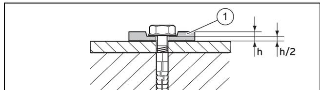
1. Montieren Sie den Fuß des Schachtaufsatzes mit jeweils 4 Schrauben und flexiblen Unterlegscheiben (1).
