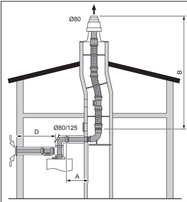
1. Beginnen Sie den Aufbau des Systems mit der Montage der flexiblen Abgasleitung (→ Seite 27) oder der unter Beachtung der entsprechenden Rohrlängentabellen.
