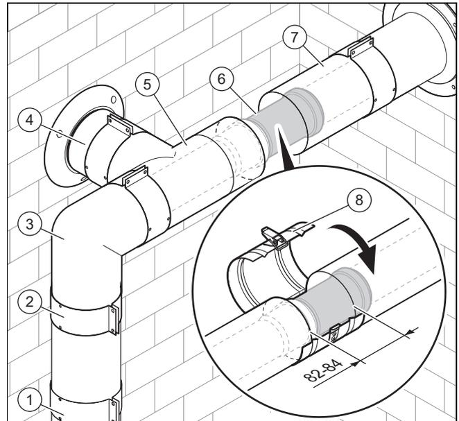
9. Verbinden Sie das Anschlussstück für die Luft-Abgas-Führung (1) mit den Bogen (3).
