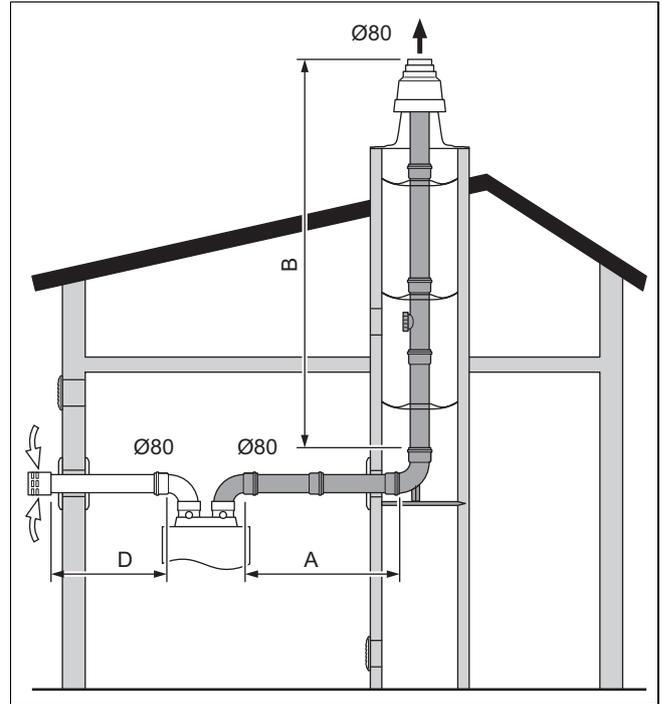
1. Beginnen Sie den Aufbau des Systems mit der Montage der starren Abgasleitung (→ Seite 27) unter Beachtung der entsprechenden Rohrlängentabellen.
