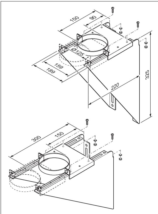
5. Montieren Sie die Trägerplatte auf die Halter (6) der Außenwandkonsole.
