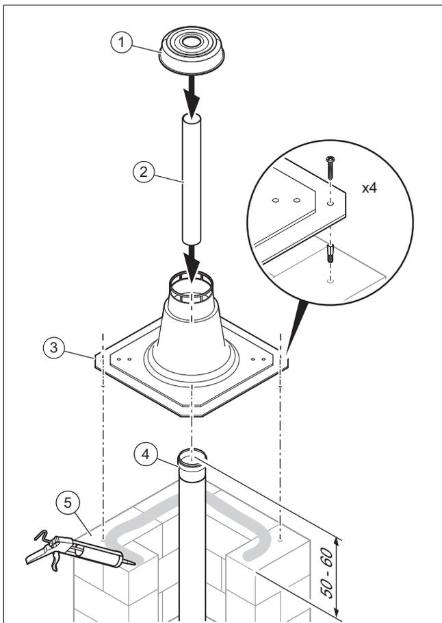
2. Kürzen Sie das oberste Abgasrohr (4) auf die erforderliche Länge.
