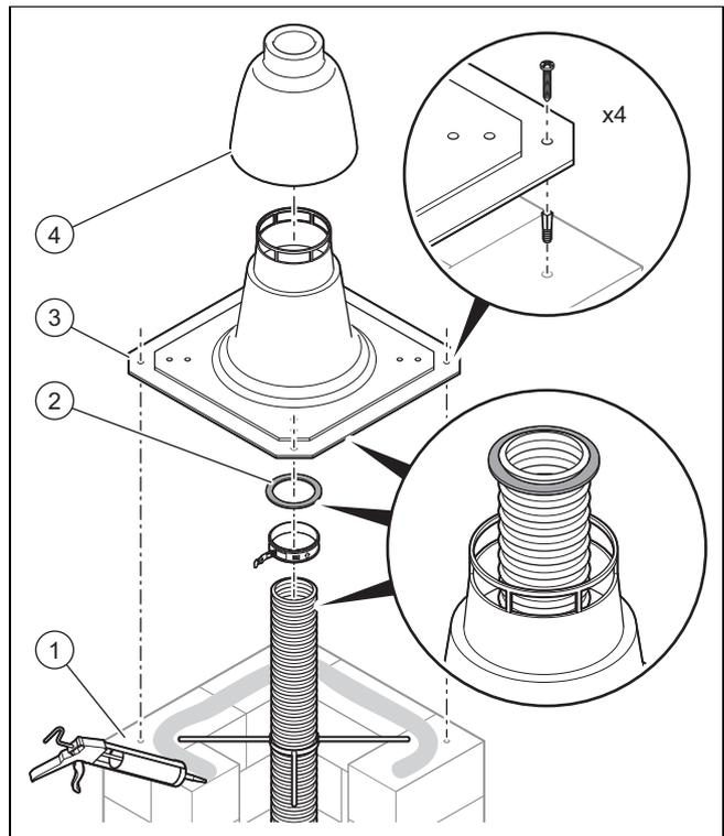
2. Dichten Sie den Mündungsrand (1) des Schachts mit Silikon ab.
