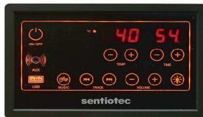
Stisknutím tlačítka **Zap/Vyp** zapněte řídicí jednotku. Topné prvky se začnou zahřívat. Zobrazí se teplota v kabině a doba provozu. Doba provozu se automaticky nastaví na hodnotu 60 minut nebo na poslední zvolenou dobu. Pokud znovu stisknete tlačítko **Zap/Vyp**, všechny funkce (topná tělesa, světlo a hudba) se vypnou.
