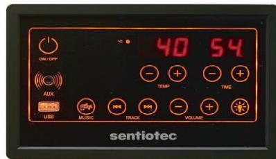
Premere il tasto **On/Off** per accendere il comando. Gli elementi riscaldanti inizieranno a riscaldarsi. Vengono visualizzati la temperatura della cabina e il tempo di funzionamento. Il tempo di funzionamento si attiva automaticamente su 60 minuti o sull'ultimo tempo selezionato. Se si preme nuovamente **On/Off**, tutte le funzioni (elementi riscaldanti, luce e musica) si spengono.
