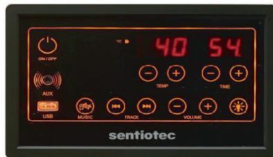
Käynnistää ohjain painamalla **pääälle/pois**-symbolia. Lämmitysvastukset aloittavat lämmityksen. Saunan lämpötila ja lämmityksen toiminta-aika ovat näytössä. Lämmityksen toiminta-aika on automaattisesti 60 minuuttia tai viimeksi valitun toiminta-ajan mukainen. Mikäli painat uudelleen **pääälle/pois**-symbolia, kaikki toiminnot (lämmityselementit, valaistus ja musiikki) kytkeytyvät pois päältä.
