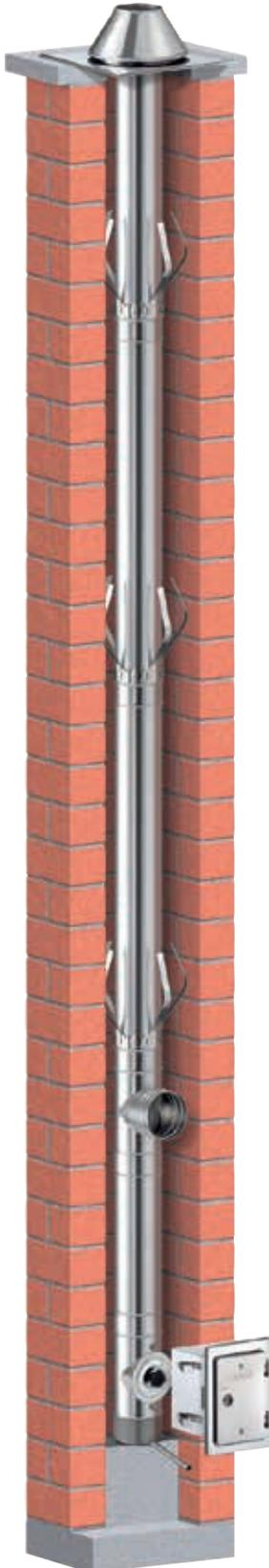
Schiedel **PRIMA PLUS** ist ein Sanierungssystem für bestehende Schornsteine aus hochwertigem Edelstahl. Speziell geeignet für Öl- und Gasfeuerstätten im Unter- und Überdruckbetrieb. Darüber hinaus können an **PRIMA PLUS** auch Festbrennstoff-Feuerstätten im Unterdruck angeschlossen werden.
