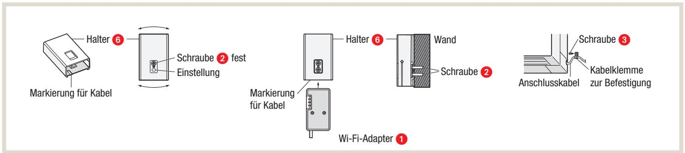
1. Das Kabel des Wi-Fi-Adapters **1** sollte nach unten zeigen.
