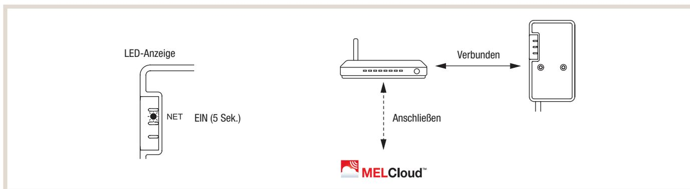
3. Die LED-Anzeige entspricht der unten abgebildeten, wenn die Verbindung hergestellt wurde.
