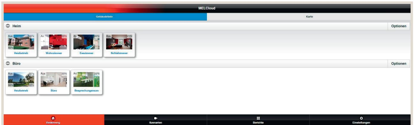
Über die MELCloud Gebäudeansicht können die Anlagen nach Gebäuden und Stockwerken sortiert werden. In der Übersicht sind alle Gewerke gemeinsam abgebildet und ermöglichen den direkten Zugriff auf die einzelne Anlage.
