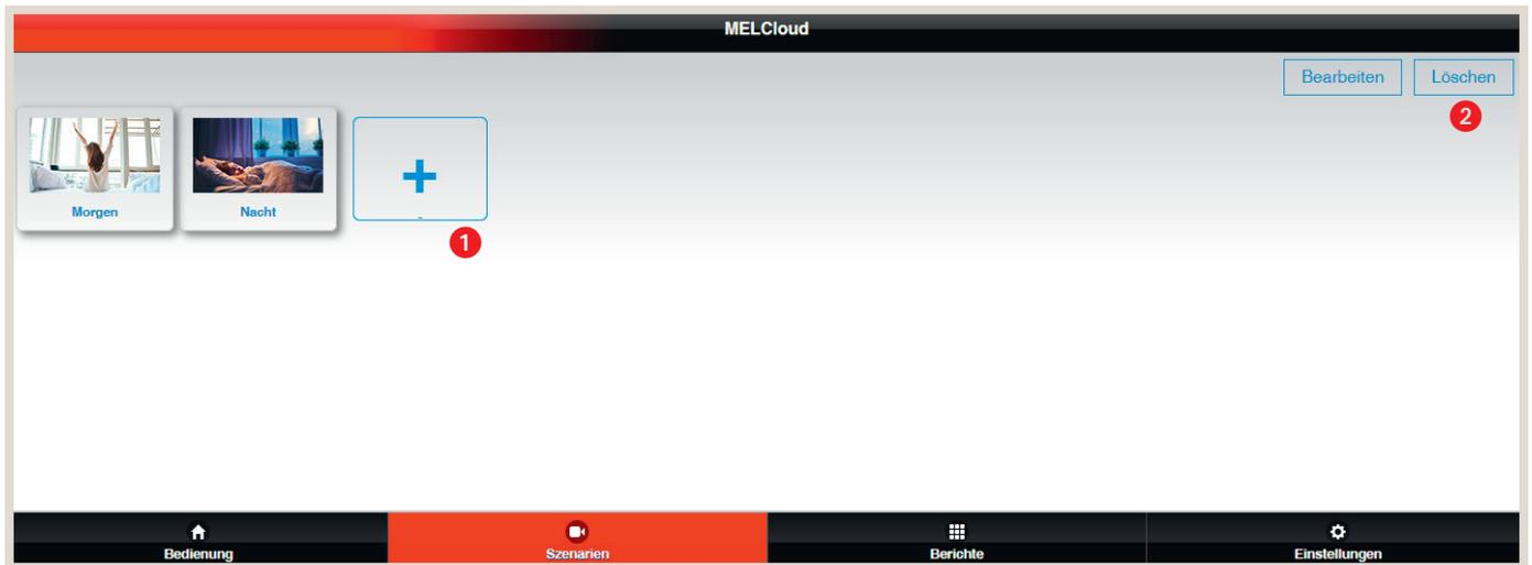
Mit Szenarien können einzelne Geräte, Gerätegruppen oder mehrere Standorte systemübergreifend gesteuert werden. Die Szenarien sind frei konfigurierbar. So kann z. B. ein Szenario „Abwesend“ und „Anwesend“ erstellt werden. Mit einem Knopfdruck können alle ATA/ATW- oder Lossnay-Geräte in die konfigurierten Operationsmodi gebracht werden.
