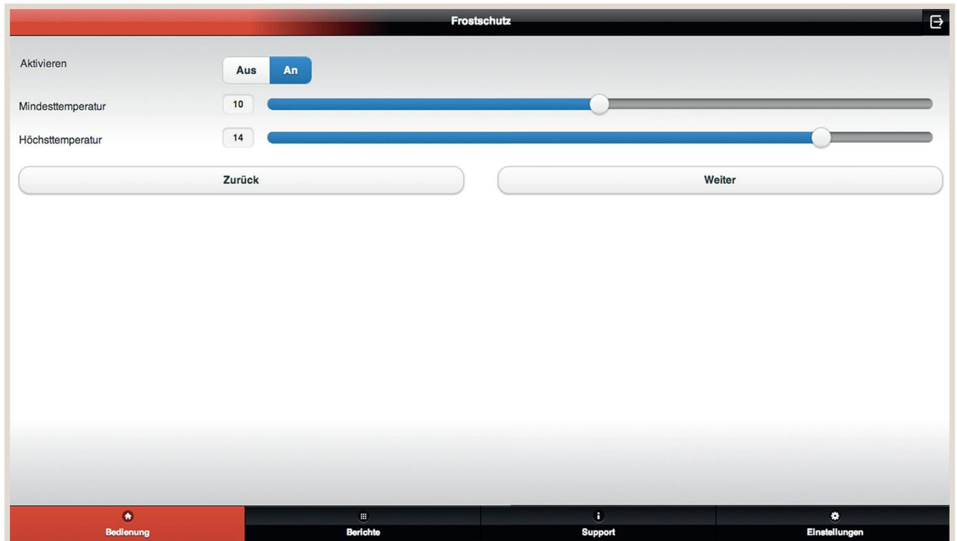
Unter „Frostschutz“ können Sie eine minimale Raumtemperatur einstellen. Sobald die Raumtemperatur unter diesen Wert fällt, heizt die Anlage automatisch den Raum auf diese Temperatur auf. So schützen Sie Raum und Bausubstanz vor möglichen Schäden, die durch niedrige Temperaturen verursacht werden können.
