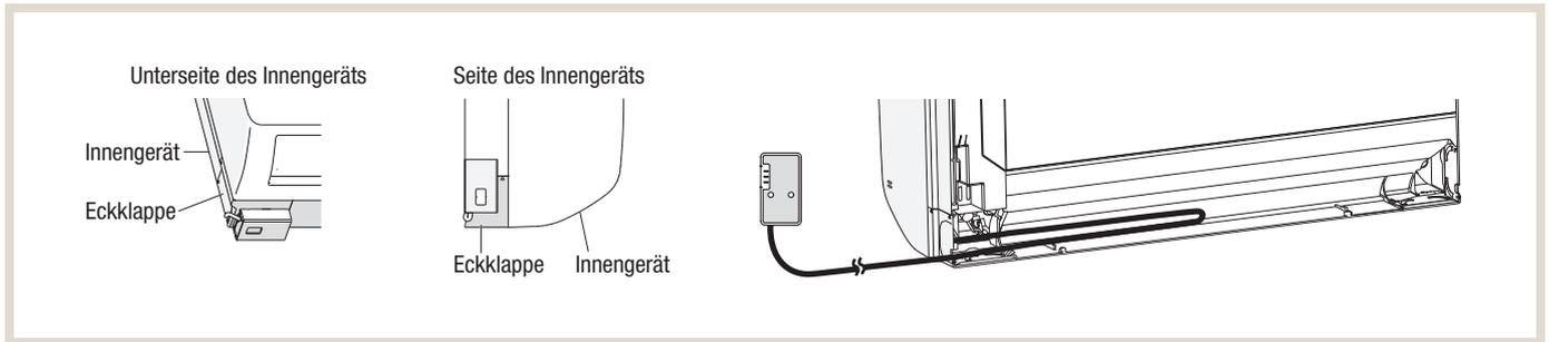
1. Legen Sie das Anschlusskabel wie in der Abbildung oben gezeigt in den Platz auf der Rückseite des Geräts.
