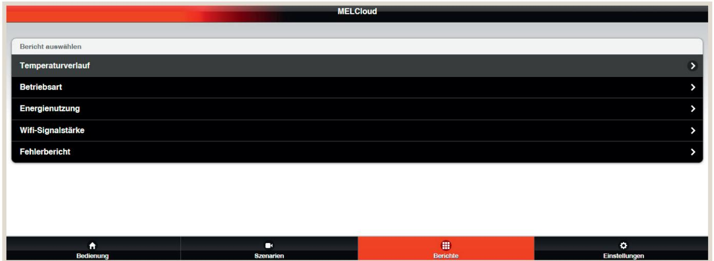
MELCloud speichert automatisch die erfassten Daten und fasst sie im Menü „Berichte“ übersichtlich zusammen. So können zum Beispiel Temperaturen oder der Energieverbrauch einzelner oder mehrerer Anlagen, für einen frei definierbaren Zeitraum, bequem und einfach angezeigt werden.
