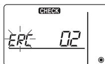
(Fehleranzeige 3) „ERC“ und der Datenfehlerzählwert wird angezeigt → Datenfehlererzeugung
