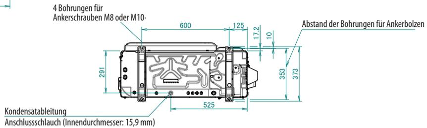
Mit abgenommener Absperrventilabdeckung
