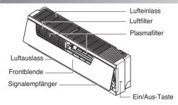
Ein/Aus : Leuchtet während des Betriebs, bei Störungen sowie beim automatischen Neustart.
