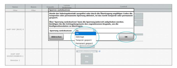
Nachdem der Button "OK" in der WebUI betätigt wurde, muss zusätzlich am Keypad die Taste "Verriegeln" zur Bestätigung gedrückt werden. Daraufhin wird der Befehl vom Keypad verarbeitet und die Servicemeldungen ausgeblendet.
