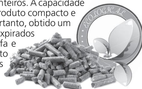
**Para as nossas estufas se tem que usar pellets de 6 mm de diâmetro, comprimento de 30 mm e um teor máximo de humidade de 8%. Recomenda-se armazenar os pellets longe de fontes de calor e humidade em locais sem ou sem atmosferas explosivas. A empresa recomenda utilizar combustível certificado.**
