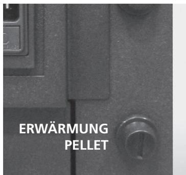
**Sicherheitsvorrichtung Pellettanktemperatur:** in den seltensten Fällen, wo die Temperatur im Pellettank den Wert übersteigt, erzeugt der Thermostat für die Pellettanktemperatur den Alarm *"ALAR-SIC-FAIL"* und unterbricht den Ofenbetrieb. Der Kunde muss einen Neustart durchführen, indem er das Gerät an der Rückseite des Ofens wieder zurücksetzt.
