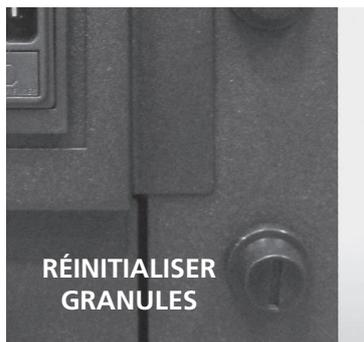
**Dispositif de sécurité température des granulés de bois:** si une température excessive se vérifie à l'intérieur du réservoir, le thermostat de sécurité des granulés de bois à réarmement manuel générerait une alarme "ALAR-SIC-FAIL" pour interrompre le fonctionnement de la poêle. Le rétablissement doit être effectué par le client en réarmant ce dispositif placé derrière l'appareil.
