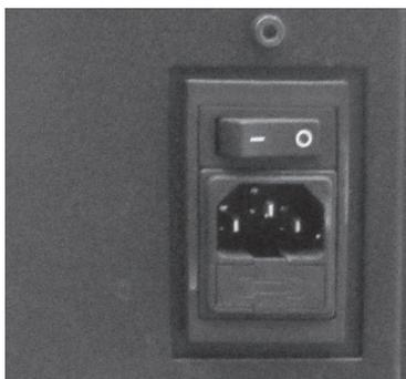
**Sécurité électrique:** le poêle est protégé contre les brusques coupures d'électricité (ex. foudre) par un fusible général à 4 A placé sur le panneau de contrôle situé à l'arrière de la poêle près du cordon d'alimentation. Les fusibles de protection des cartes électroniques sont disponibles sur les planches.
