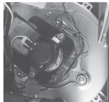
**Sensor de temperatura do fumo:** este termopar controla a temperatura do fumo e dá a ordem de acender ou apagar a estufa quando a temperatura do fumo desce por baixo do valor de referência.
