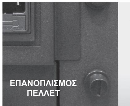
**Θερμοκρασία ασφαλείας πέλλετ** Σε πολύ σπάνιες περιπτώσεις όπου αναπτύσσεται υπερβολική θερμοκρασία μέσα στη δεξαμενή, ο θερμοστάτης ασφαλείας πέλλετ με χειροκίνητο επανοπλισμό δίνει συναγερμό *ALAR-SIC-FAIL* διακόπτοντας τη λειτουργία της σόμπας. Η επαναφορά θα πρέπει να γίνει από τον χρήστη, επανοπλίζοντας την εν λόγω διάταξη του βρίσκεται πίσω από τη σόμπα
