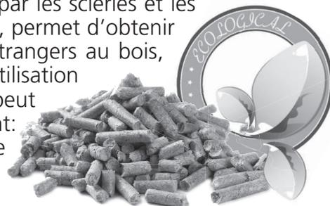
**Pour le notre poêles doivent être utilisées a granulés de bois avec un diamètre de 6 mm, longueur de 30 mm et un maximum de 8% d'humidité. Conserver les granulés de bois loin des sources de chaleur et non pas dans des environnements humides ou avec des atmosphères explosives. Nous conseillons d'utiliser du combustible certifié.**
