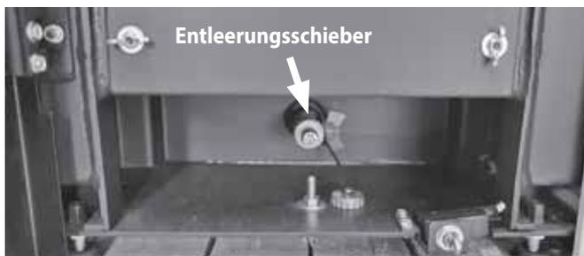
Über einen an den **Entleerungsschieber** angeschlossenen Schlauch kann das im Gerätekegel befindliche Wasser abgeleitet werden.
