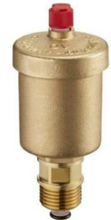
2. Alle Entlüfter des gesamten Heizungssystem regelmäßig auf Dichtheit kontrollieren. Bei Austritt von Flüssigkeiten Schnellentlüfter austauschen. Die Entlüftungskappe muss lose sein (ca. zwei Umdrehungen aufschrauben), um eine korrekte Funktion zu gewährleisten.
