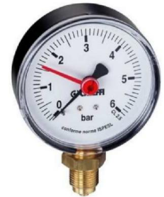
1. Prüfung bei kalter Anlage durchführen. Anlagendruck am Manometer ablesen und vergleichen mit Wert bei der Inbetriebnahme. Ist der Anlagendruck gesunken, Wasser nachfüllen. Tritt dies häufig auf, ist die Heizungsanlage undicht! Installateur verständigen. Falls der Vordruck des Ausdehnungsgefäß niedriger ist als der Druck der Anlage, Stickstoff nachfüllen, bis der Vordruck 0,1 bis 0,2 bar höher ist als der Anlagendruck (Nachfüllen durch Installateur).
