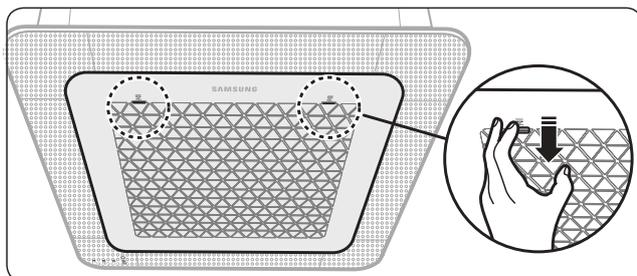
Drücken Sie die Halterungen an allen Seiten des Frontgitters nach unten, um das Gitter zu öffnen.
