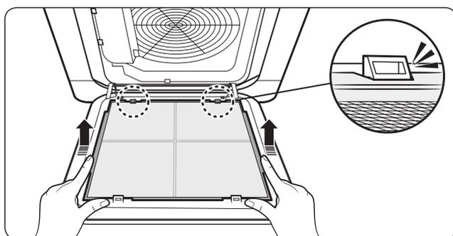
Ziehen Sie den Luftfilter aus dem Innengerät.
