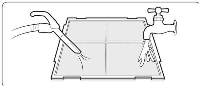
Reinigen Sie den Luftfilter mit einem Staubsauger oder einer weichen Bürste. Falls zuviel Staub vorhanden ist, mit fließendem Wasser abspülen und in einer gut belüfteten Umgebung trocknen.
