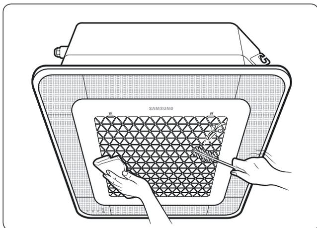
Wischen Sie die Oberfläche des Geräts bei Bedarf mit einem leicht feuchten oder trockenen Tuch ab. Entfernen Sie Schmutz aus schlecht zugänglichen Bereichen mit einer weichen Bürste.
