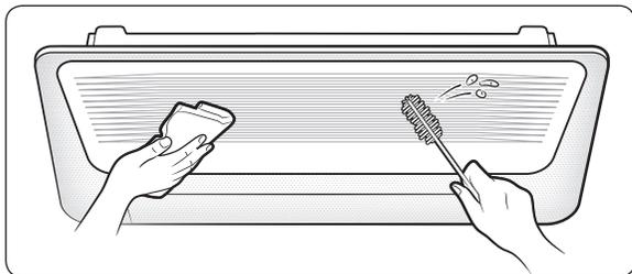
Wischen Sie die Oberfläche des Innengeräts mit einem lauwarmen, feuchten Tuch ab. Entfernen Sie angesammelten Staub aus engen Lücken mit einer weichen Bürste.
