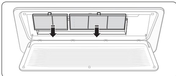
Ziehen Sie den Luftfilter aus dem Innengerät.
