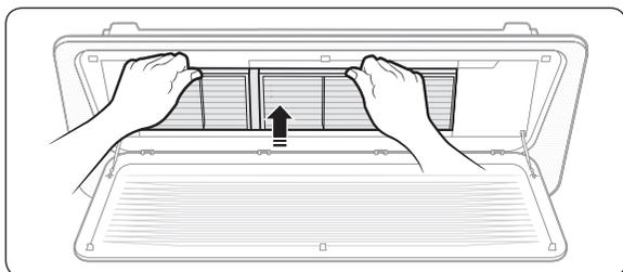
Um den Luftfilter zu montieren, führen Sie die Schritte zum Abnehmen in umgekehrter Reihenfolge aus.
