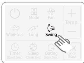
1. Drücken Sie die Taste [ **Swing** ] (**Schwingen**), um die Lamelle nach oben und nach unten zu kippen.
