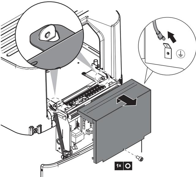
4 Wenn der Schaltkasten geöffnet wird: Trennen Sie den Erdleiter von der oberen Abdeckung des Schaltkastens.
