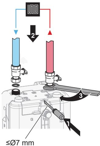
5 Schließen Sie die Wassereinlass- und -auslassrohre für Brauchwasser an das Innengerät an.
