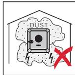
Grundsätzlich ist der Wechselrichter staubdicht (IP 66) ausgeführt. In Bereichen mit starker Staubansammlung können sich Staubablagerungen auf den Kühlflächen ansammeln und somit die thermische Leistungsfähigkeit beeinträchtigen. In diesem Fall ist eine regelmäßige Reinigung erforderlich siehe Kapitel **Betrieb in Umgebungen mit starker Staubentwicklung** auf Seite 111. Eine Montage in Räumen und Umgebungen mit starker Staubentwicklung ist daher nicht zu empfehlen.
