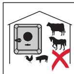
Den Wechselrichter nicht montieren in:
