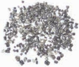
Verteilen Sie die Vermiculit Körner (15) über die Brennerplatte.
