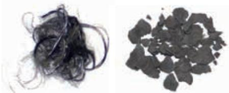
Legen Sie die Keramische Fasern (14) auf den Hauptbrenner und sichern Sie diese mit ein paar kleine Chips (13).
