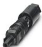
Photovoltaik-Steckverbinder, Artikelfamilie: Sunclix, Steckverbinder, Material Gehäuse: PPE, Farbe: schwarz, Polzahl: 1, Aderquerschnitt min.: 6 mm<sup>2</sup>, Aderquerschnitt max.: 16 mm<sup>2</sup>, Bemessungsspannung: 1500 V DC, Bemessungsstrom: 65 A, Anschlussart: Federkraft, Kontaktart: Buchse, Kabeldurchmesser min.: 5,5 mm, Kabeldurchmesser max.: 10 mm
