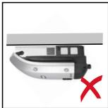
Den Wechselrichter nicht an der Decke montieren.
