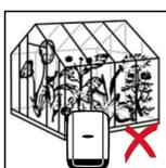
Den Wechselrichter nicht montieren in:
