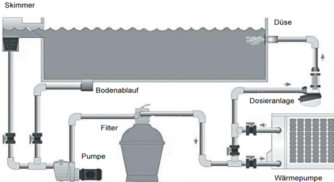
Diese Abbildung dient nur zur Veranschaulichung. Bitte lassen Sie sich von zugelassenen Technikern beraten. Die Wärmepumpe wird über einen Bypass mit dem Wasserkreislauf verbunden, um einen optimalen Durchfluss zu haben.
