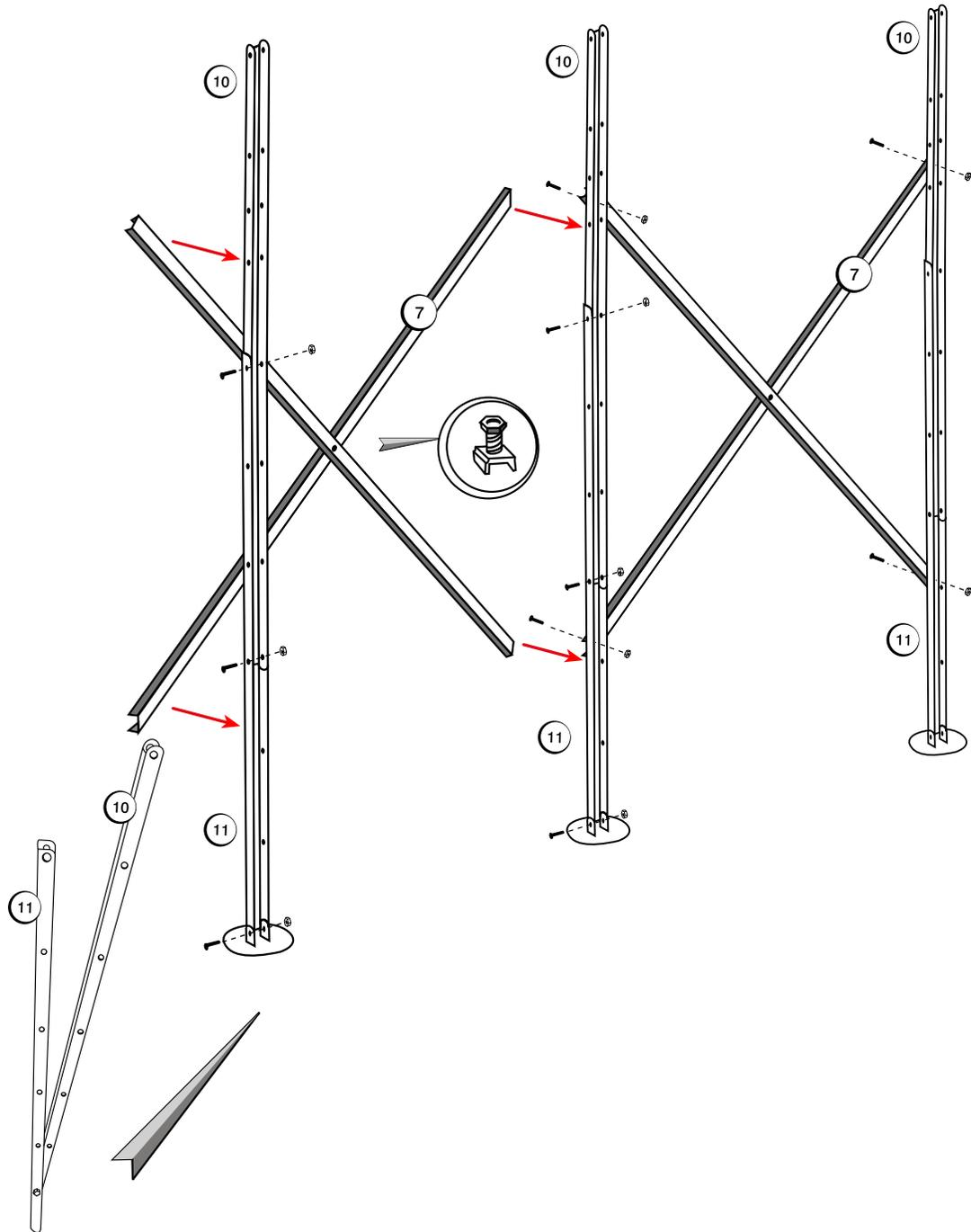
Montageanleitung für Solarkollektor mit 24 oder 30 Röhren
