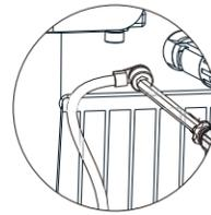
( $\phi$  Sechskantschlüssel. Anzugsmoment:  $1,5 \pm 0,2$  Nm)
