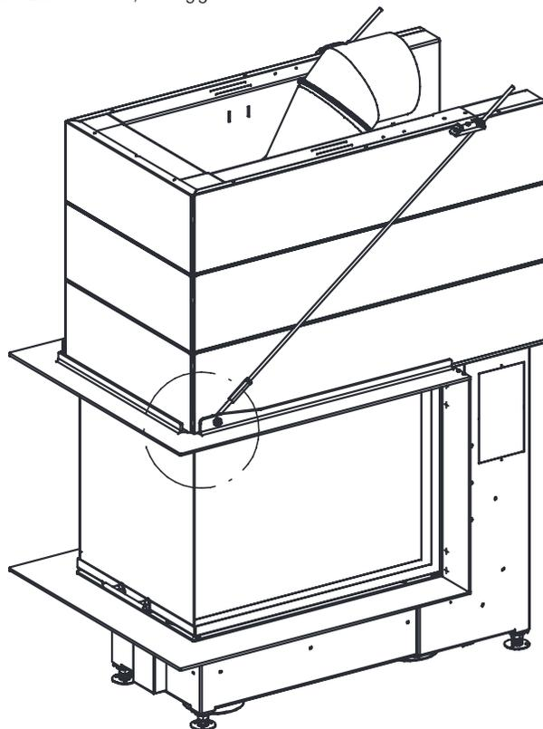
Bei deckenbündigen Aufbauten der Heizkammer oder Aufbauten mit hohem Eigengewicht ist die selbsttragende Blende bauseitig zu befestigen. Hierzu sind die Zugstangen von der Brennzelle zu lösen und an der Anbauwand oder an der Decke zu befestigen. Sie können dazu z.B. Einschlaganker in Kombination mit Gliedketten aus Stahl, abhängig von der Wandkonstruktion verwenden.
