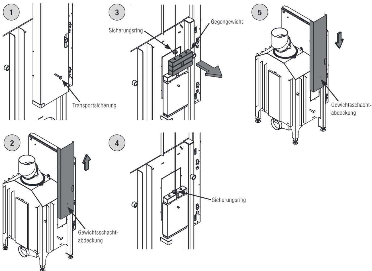
1. Transportsicherung und Befestigungsschrauben entfernen.
