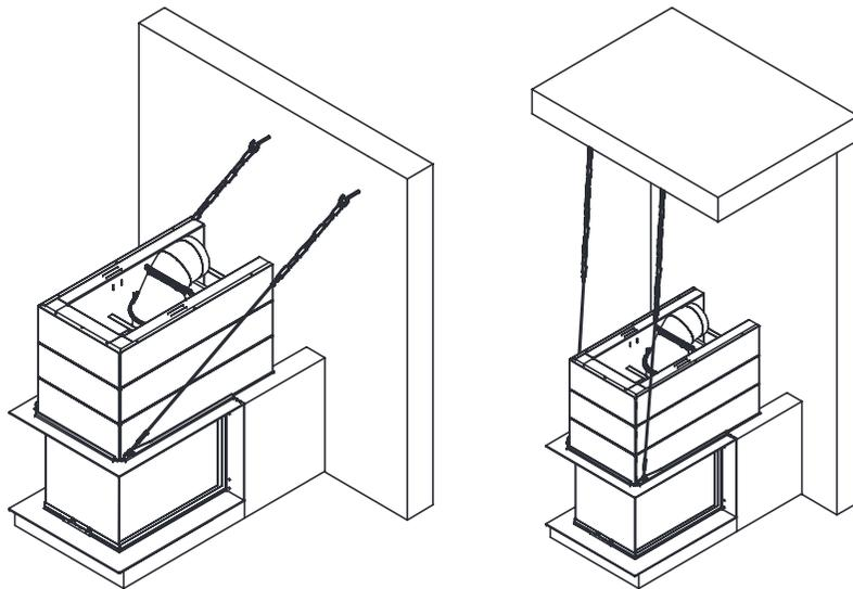
Die Ausrichtung der Blende sollte mit der Wasserwaage erfolgen. Während der Montage und Erstellung der Heizkammer ist darauf zu achten, dass Tragrahmen und Blende nicht tiefer wie die Türhaube der Brennzelle positioniert wird. Die Hochschiebbarkeit bzw. das Aufschwenken der Feuerraumtür für Reinigungszwecke ist zu prüfen. **Die Feuerraumtür muss sich leichtgängig, ohne Widerstand frei bewegen und öffnen lassen.**
