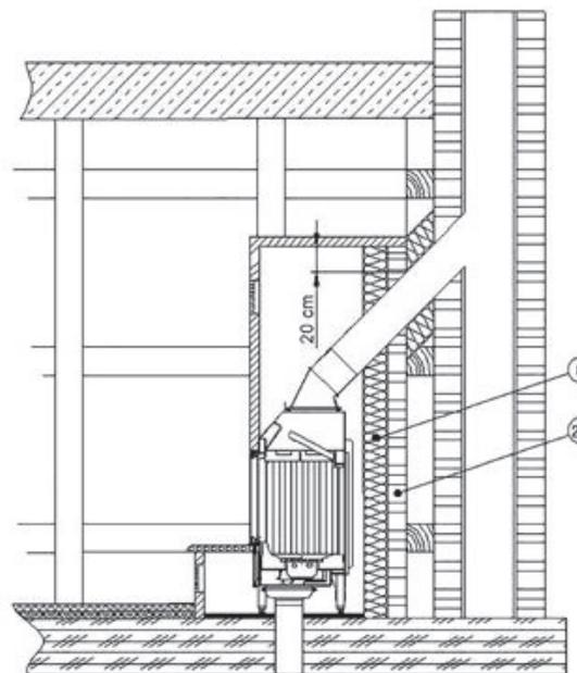
8 Dämmung der Heizkammer gemäß den Wärmedämmstoffdicken der technischen Daten
