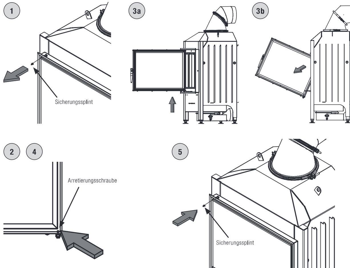
1. Sicherungssplint zwischen Zarge und Tür entfernen.
