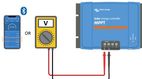
2. Verwenden Sie ein Multimeter, um die Spannung an den Batterieklemmen zu messen.
