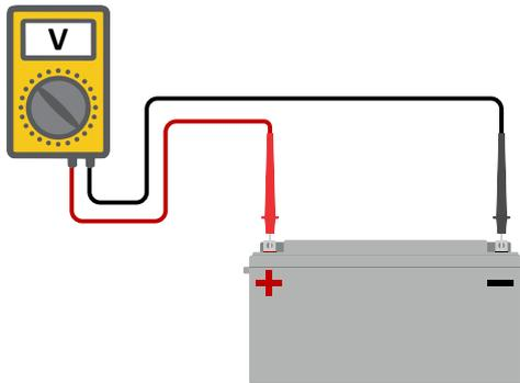
3. Vergleichen Sie die beiden Spannungen, um festzustellen, ob ein Spannungsunterschied besteht.
