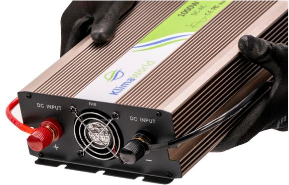
Der Wechselrichter ist nun für den Anschluss an die Batterie vorbereitet.
