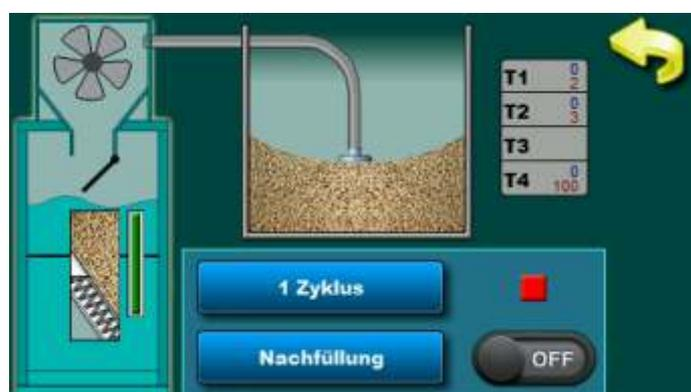
Mit dieser Option kann der Servicetechniker die Betriebszeiten des Vakuumsystems einfach einstellen. Durch einschalten der Option 1 Zyklus oder Befüllen und durch Überwachung der Zeit in der Tabelle und des Befüllens des Turbinenbehälter (über den durchsichtigen Plexideckel des Turbinenbehälter) werden die Betriebszyklen bestimmt: Start, Betrieb und Ende.
