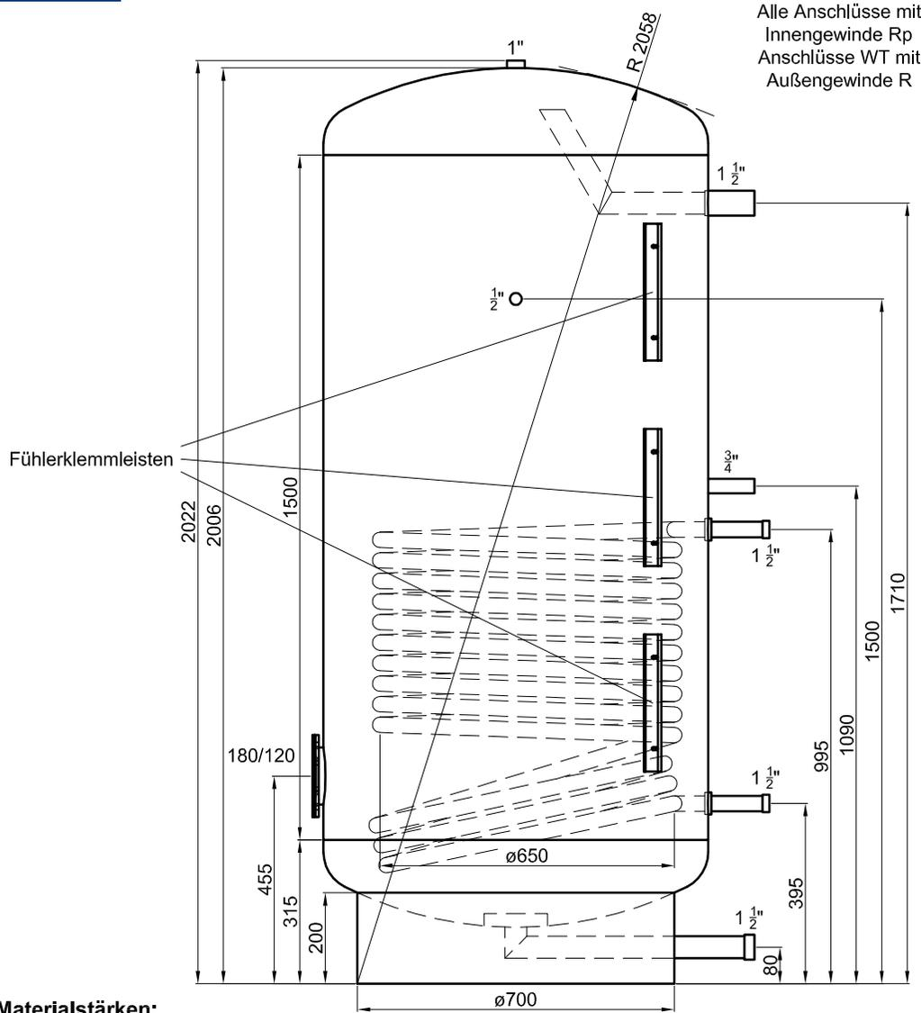
Alle Anschlüsse mit Innengewinde Rp
