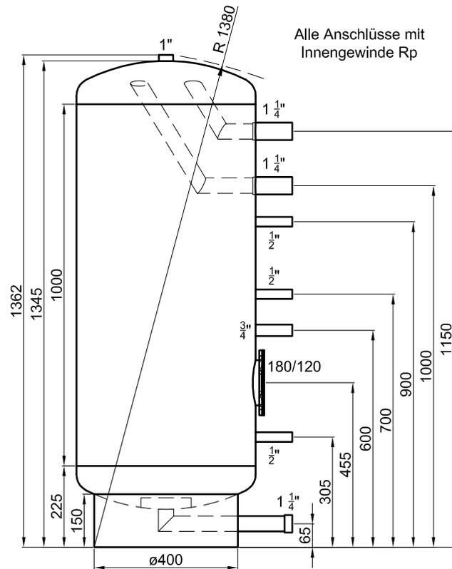
Alle Anschlüsse mit Innengewinde Rp
