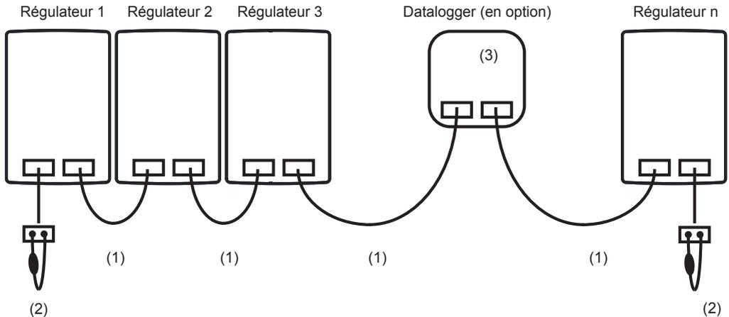
1. Le centraline sono collegate in serie con il cavo CAN bus (1).
