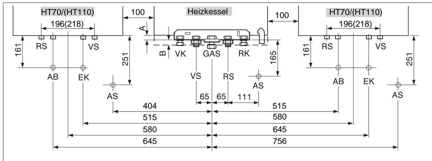
Abb. 2 Abmessungen der Hydraulikanschlüsse, Vorderansicht
