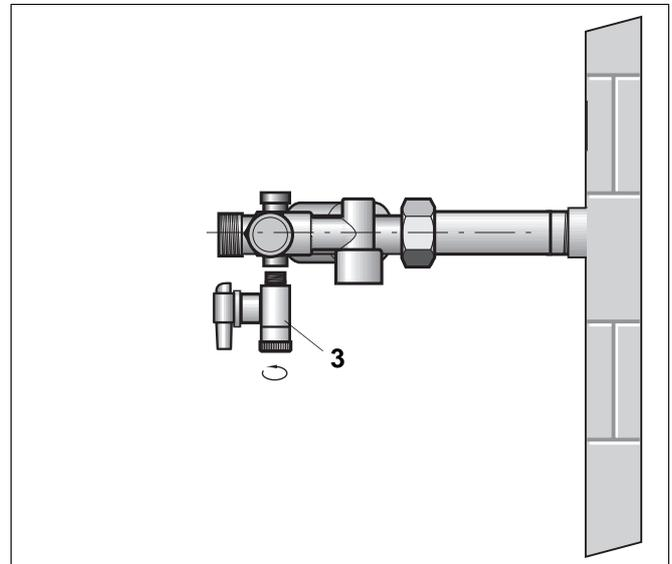
Abb. 11 Montage KFE-Hahn zur Entleerung des Speichers
