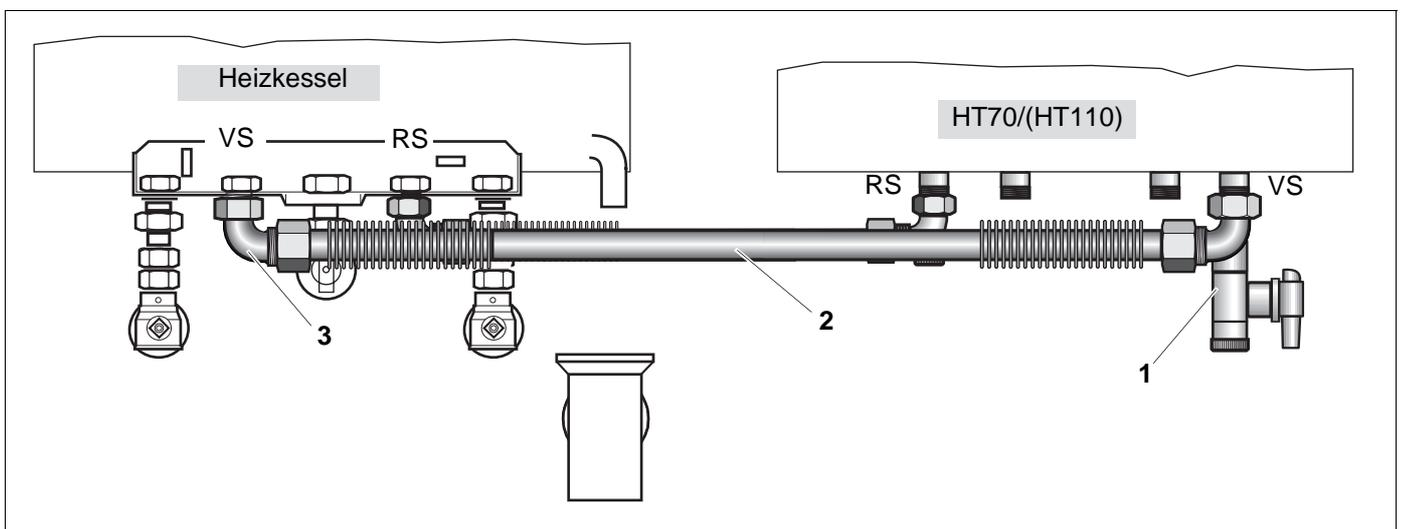
Abb. 9 Verbindungsrohr Speicherrücklauf HT70/HT110 **rechts** (ohne Wärmeschutz dargestellt)
