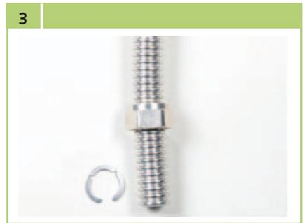
Zur Herstellung der Dichtfläche benötigen Sie 1-2 Wellen des Wellrohres.
