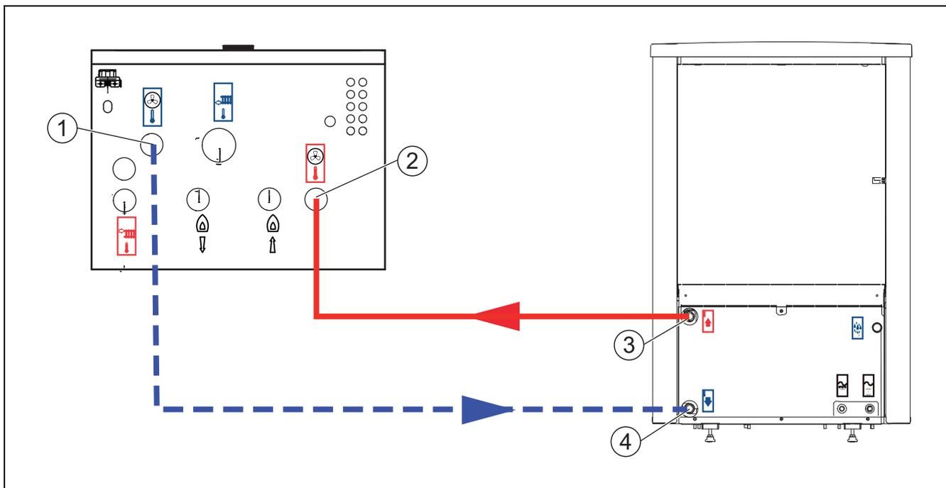
Bild 6 Anschluss der Inneneinheit an die Wärmepumpe
