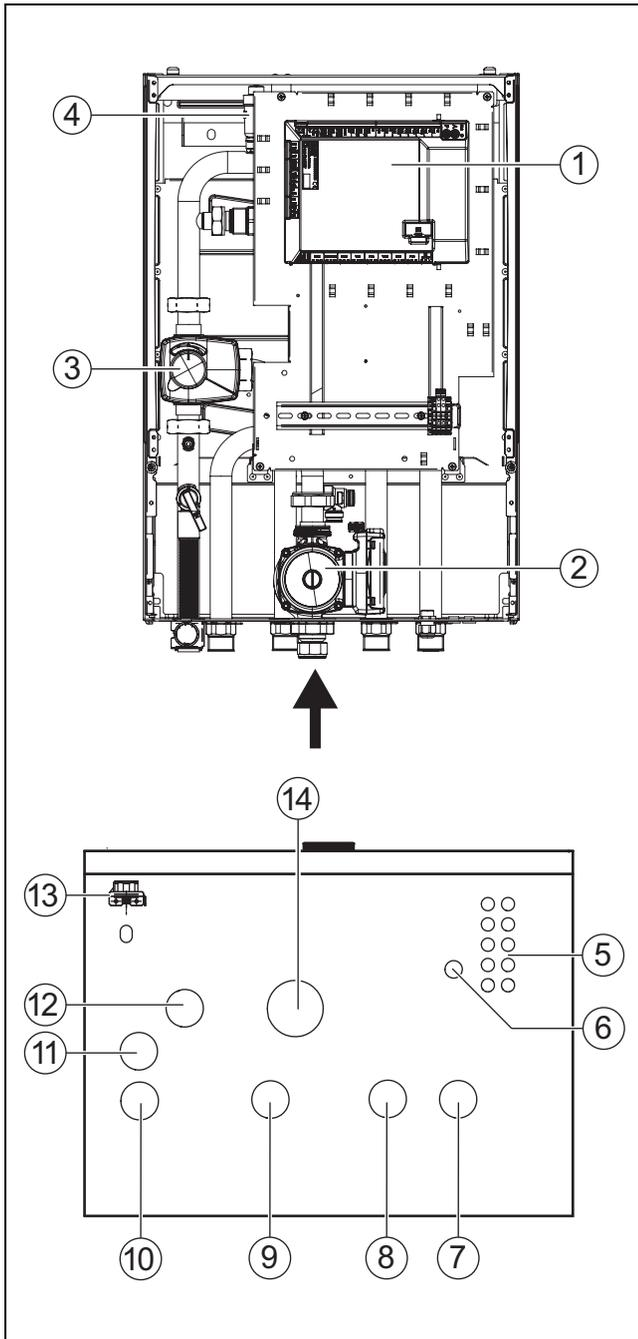
Bild 2 Bestandteile und Rohranschlüsse der Inneneinheit mit Mischer für externen Zuheizier
