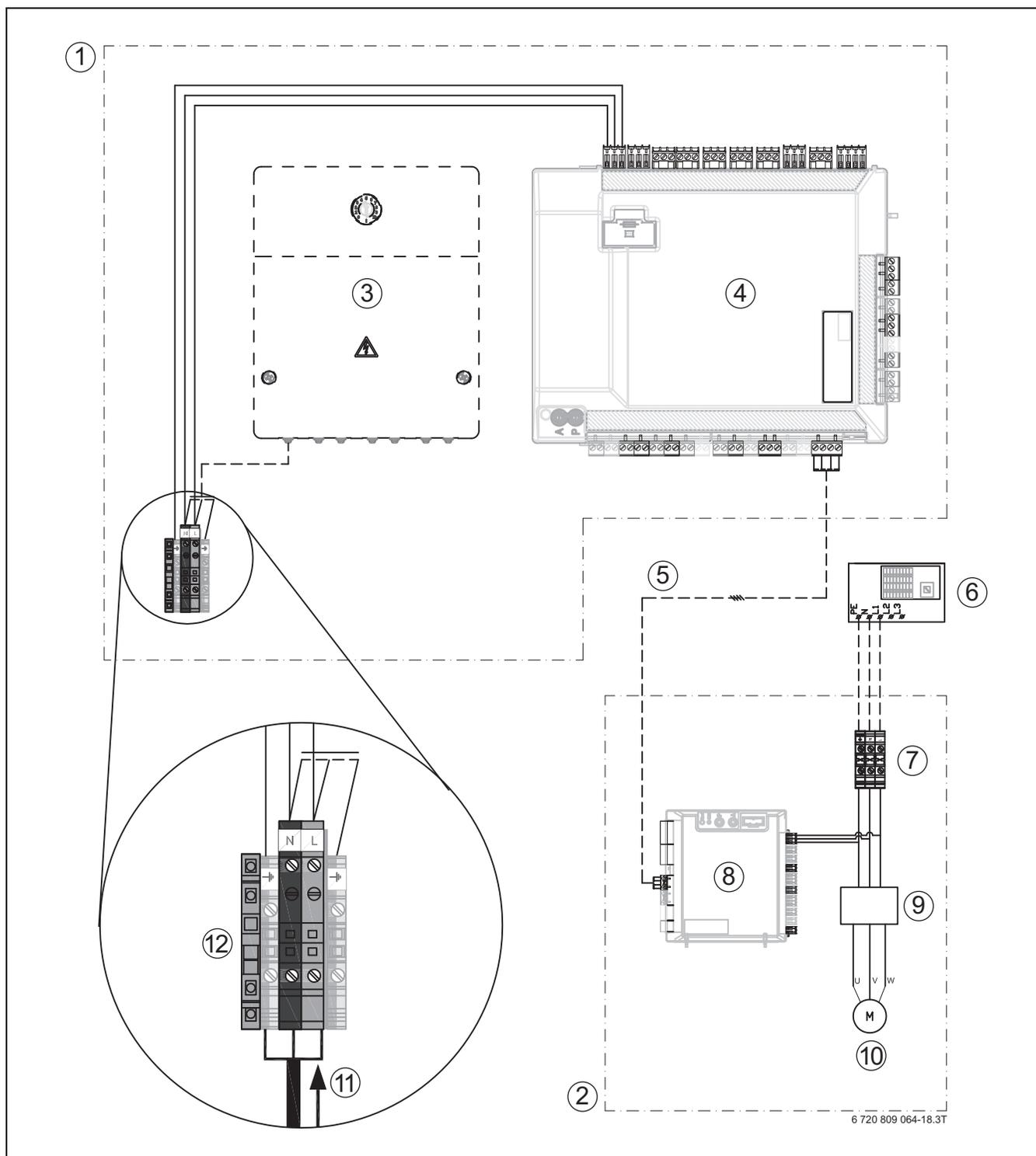
Bild 30 Einphasige Wärmepumpe und Inneneinheit mit externem Zuheizler
