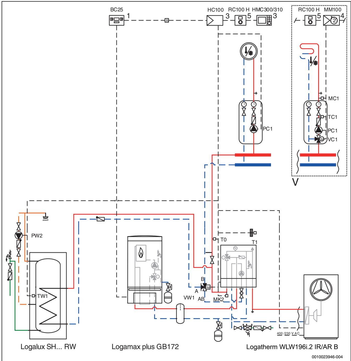
Bild 28 Zuheizer mit Mischer mit Warmwasserspeicher
