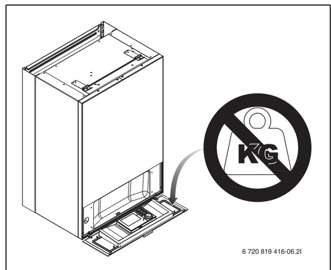
Bild 16 Bedieneinheit IDU-..iBiE
