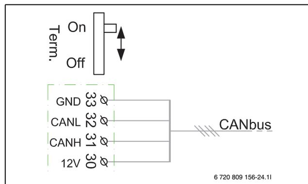
Bild 9 CAN-BUS-Terminierung
