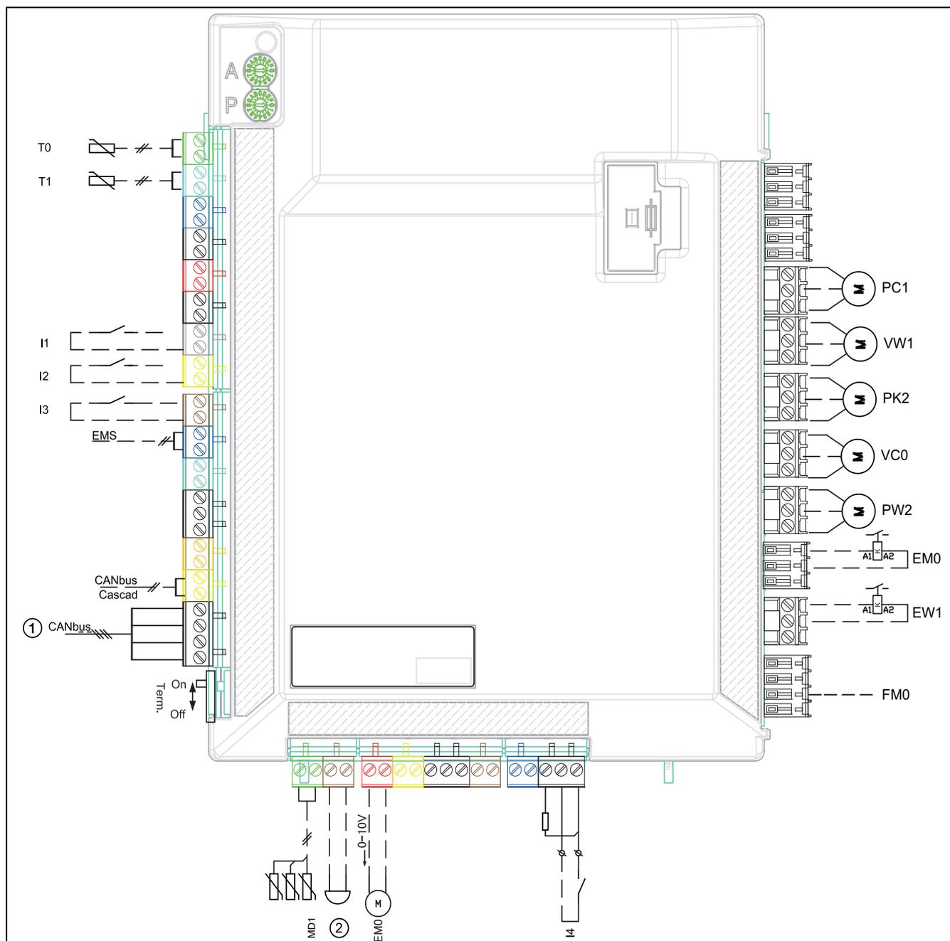
Bild 12 Anschlüsse Installationsmodul
