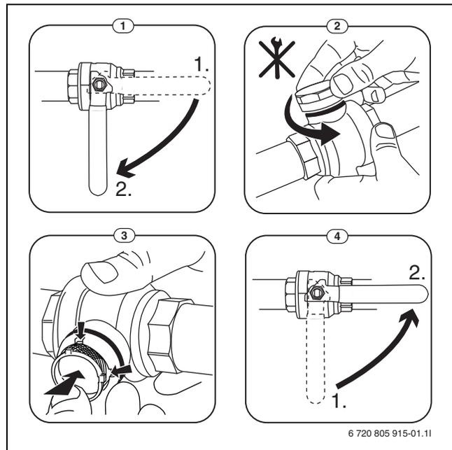
Bild 17 Siebreinigung
