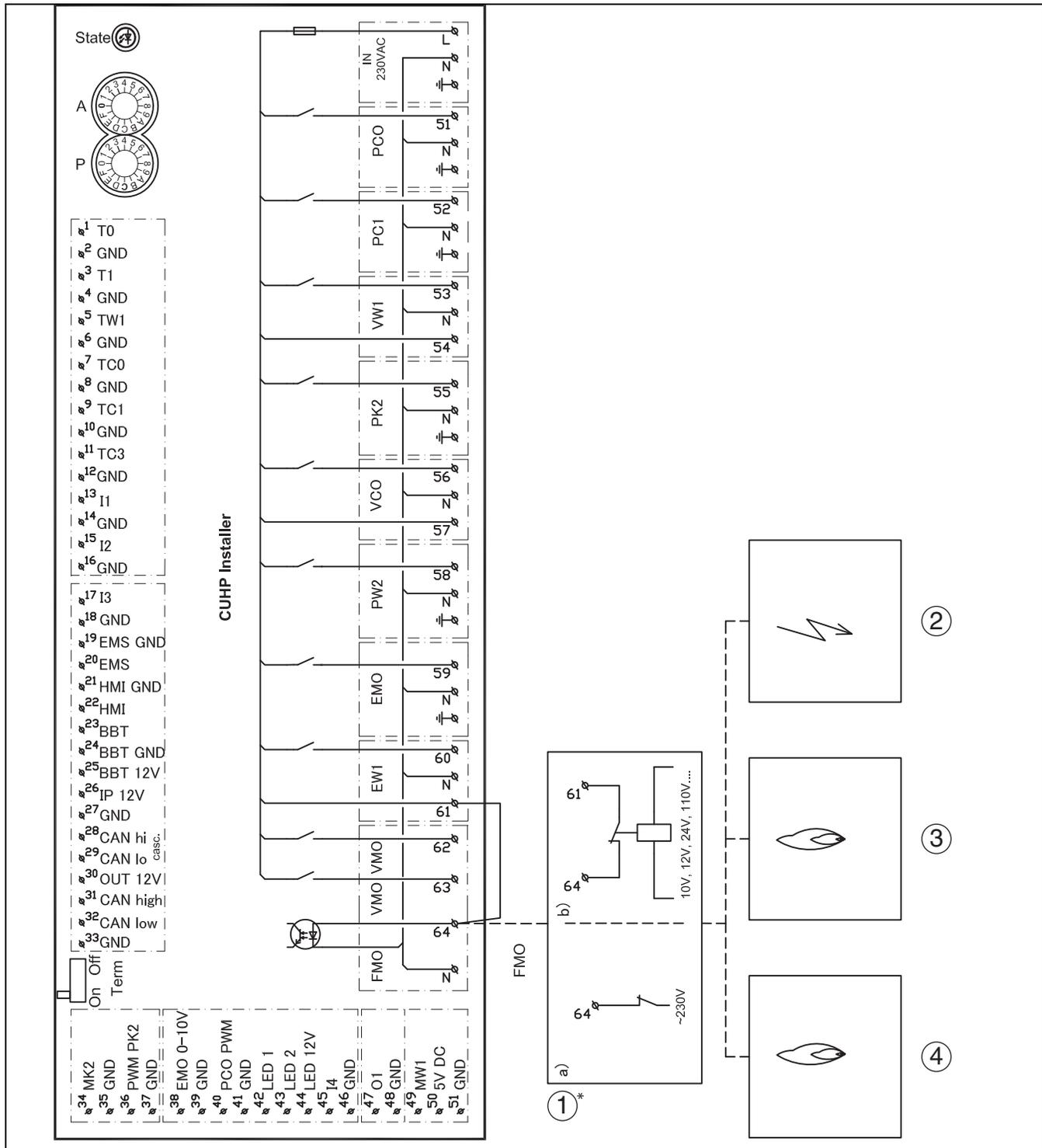
Bild 34 Schaltplan für Installationsmodul, Alarm des externen Zuheizers
