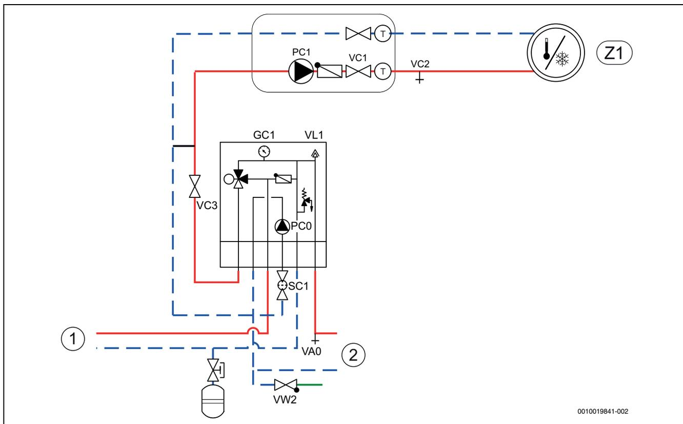
Bild 15 Inneneinheit mit externem Zuheizter und Heizsystem
