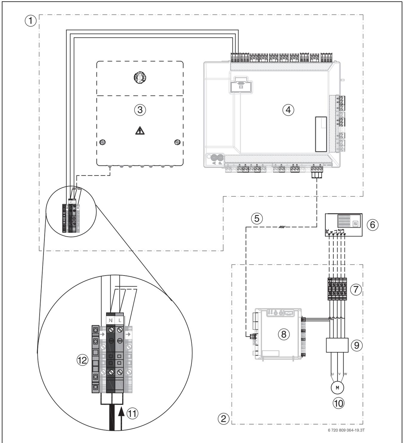
Bild 31 Dreiphasige Wärmepumpe und Inneneinheit mit externem Zuheizler
