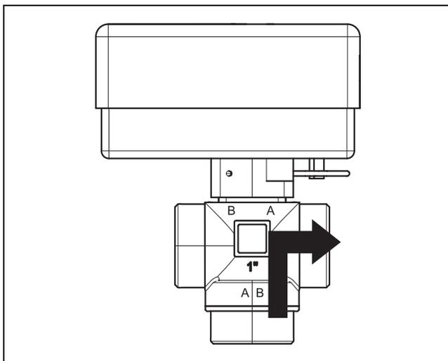
Bild 21 Kontakt geschlossen, Anschluss A offen
